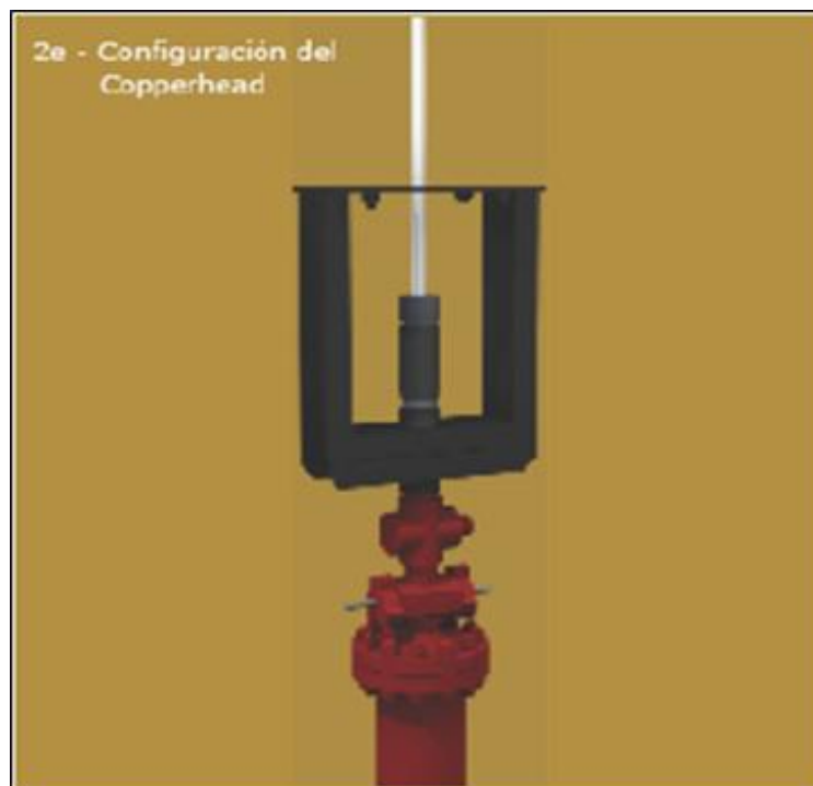
Figura 5. Instalación del pedestal
