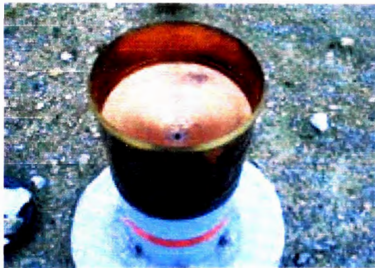
FOTO Nº 6 - PLUVIOMETRO DE INGRESO CONICO.
