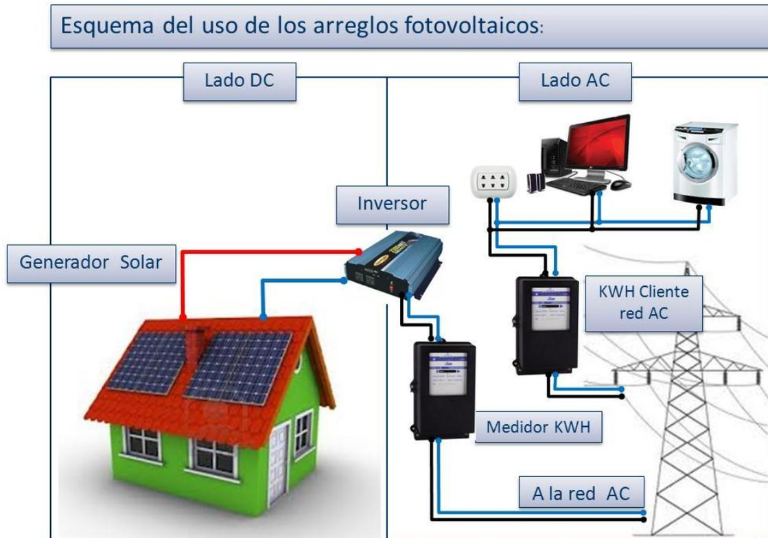
Fig. 3.4: Esquema de Sistema fotovoltaico en viviendas urbanas
