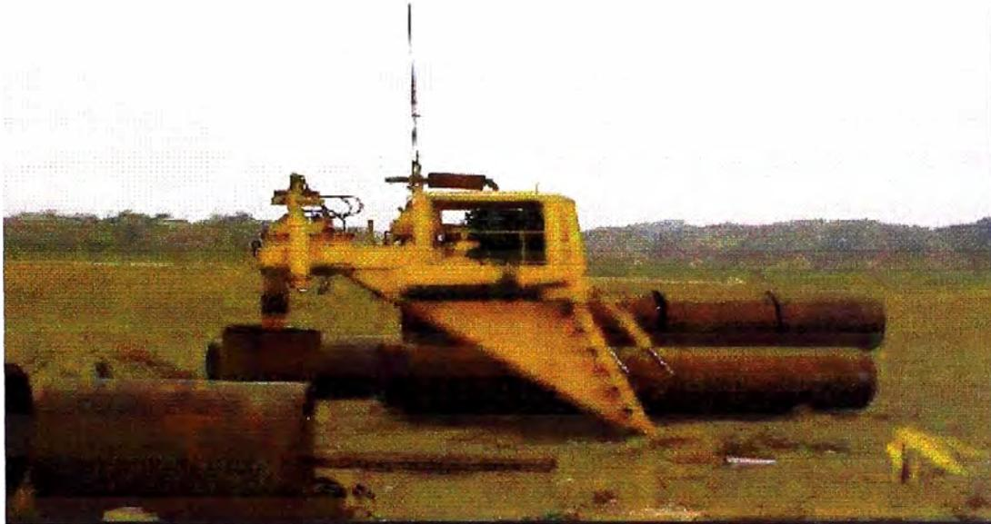
Figura II-5: Equipo de perforación por rotación.
