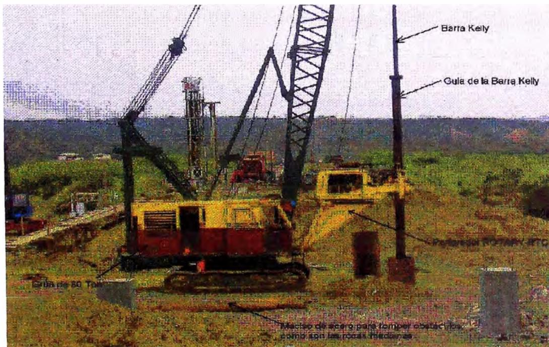
Figura II-6: Equipo de perforación por rotación acoplado a una grúa.
