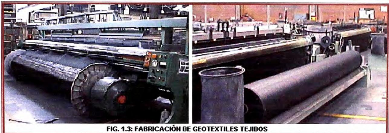
FIG. 1.3: FABRICACIÓN DE GEOTEXTILES TEJIDOS
