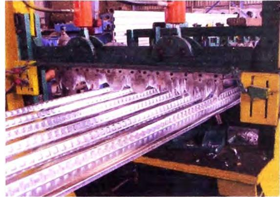
FOTO 3.3: Proceso de doblado y formación de la Lamina.
