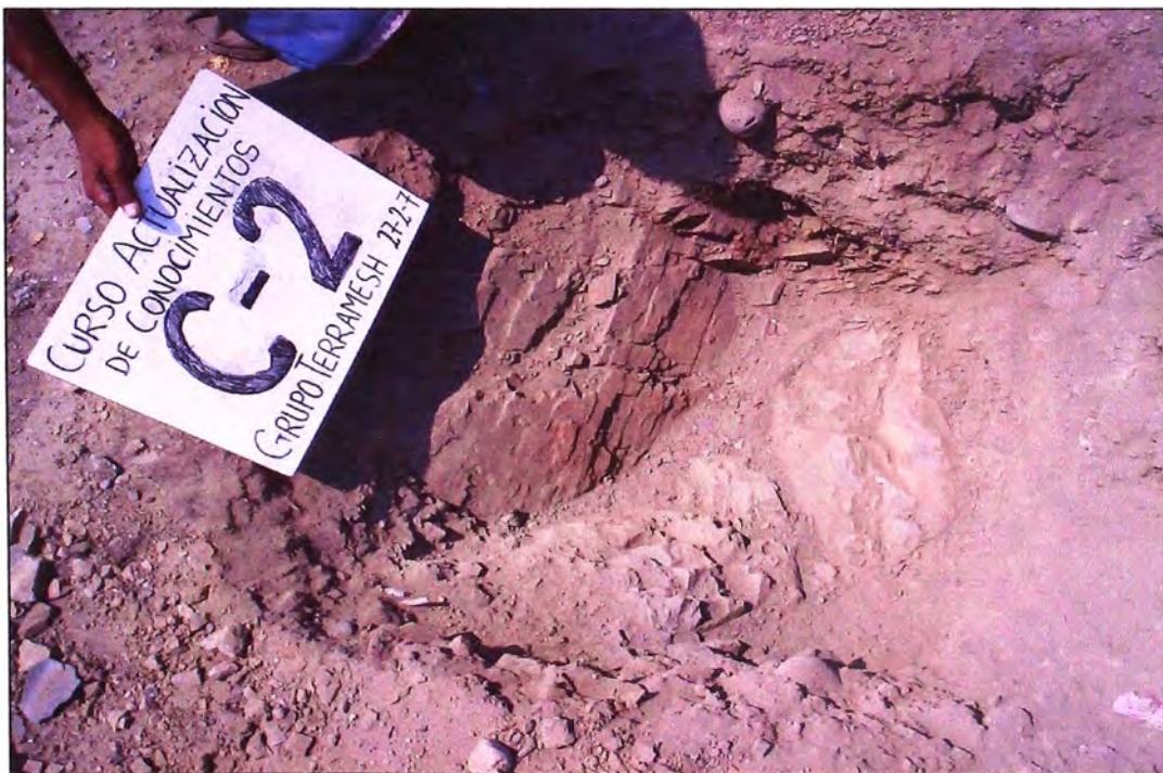
Foto 2 - Calicata C-2, se aprecia el macizo rocoso en la cimentación de la zona del proyecto
