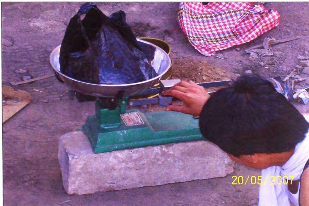
Foto 28 – Ensayo de densidad de campo.
