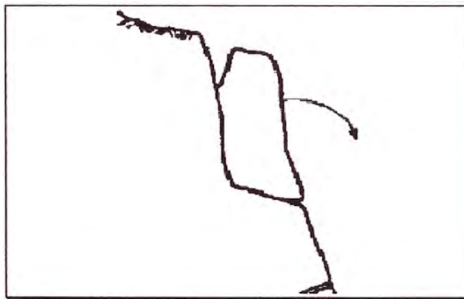
Figura 1.3 – Caída o desprendimiento de bloques
