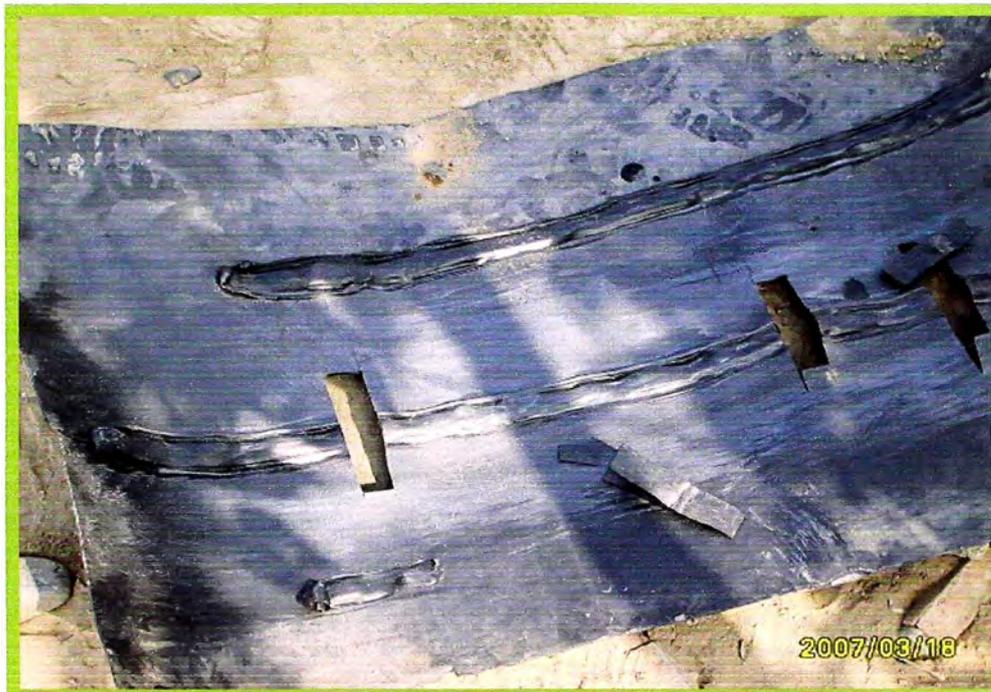
**Foto N° 23: Pruebas iniciales a la soldadura por extrusión**
