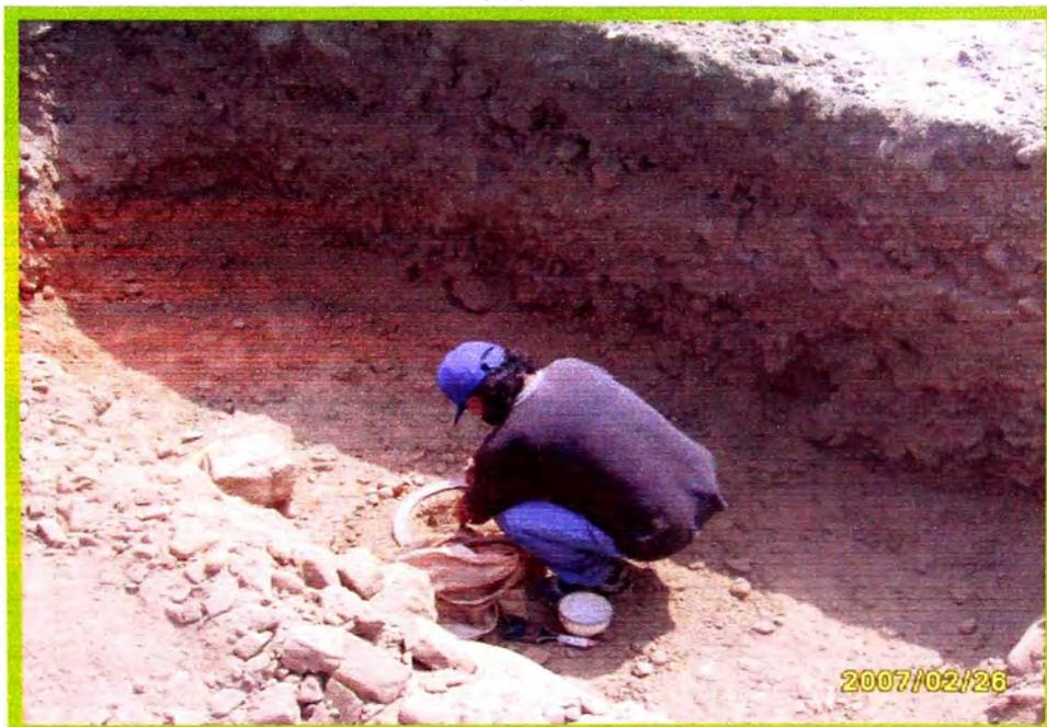
Foto N° 4: Toma de muestras para Ensayos de Suelos
