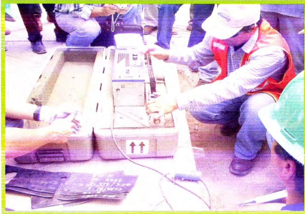
Foto N° 15: Toma de pruebas iniciales a cupones de geomembrana soldados
