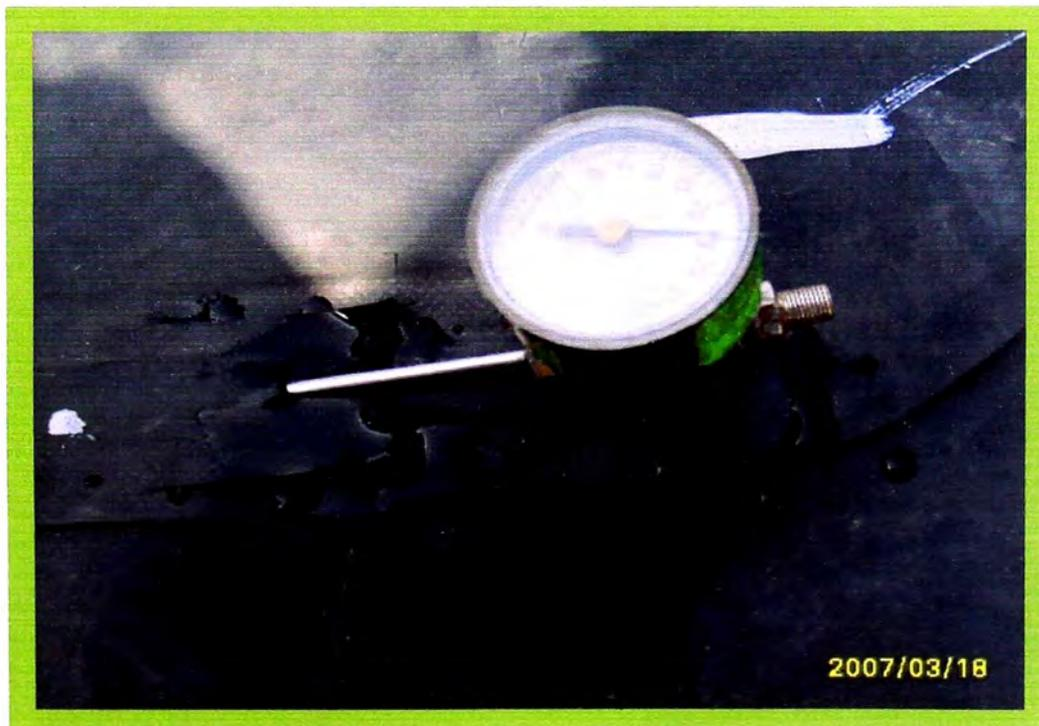
**Foto N° 20: Prueba de Aire en Soldadura por Termofusión**
