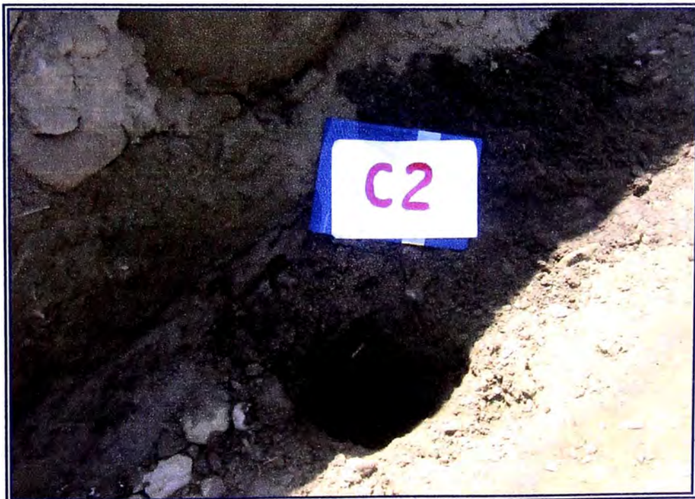
FOTO N° 6.- Se realizaron 2 calicatas al lado de la vía con profundidad de 1.5m. La segunda calicata esta ubicada en la progresiva 57+300.
