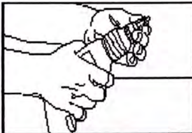
Fije la cabeza del localizador para conservar el ajuste.
