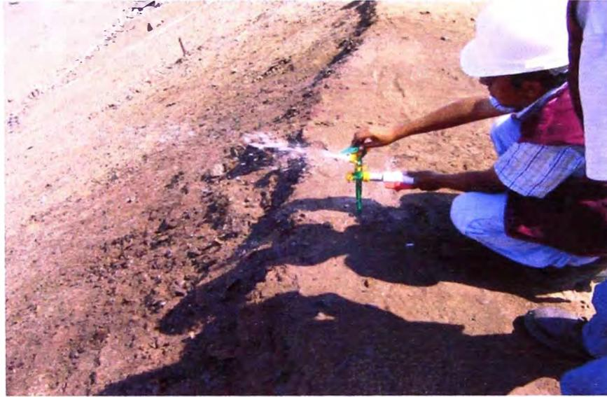
Foto 5.3: Aspersor plástico de baja presión en etapa de prueba.
