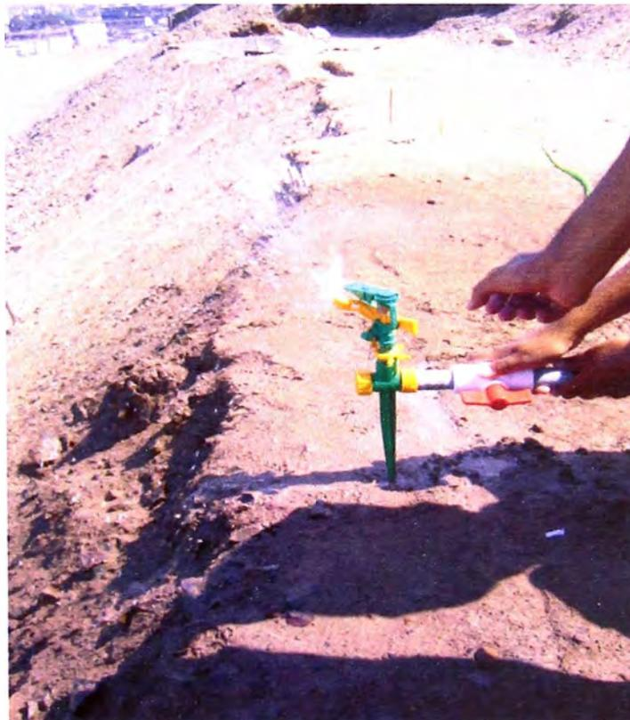
Foto 5.2: Aspersor plástico de baja presión en etapa de prueba.
