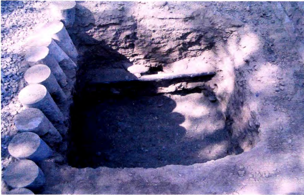
Foto 9. Poza de prueba excavada
