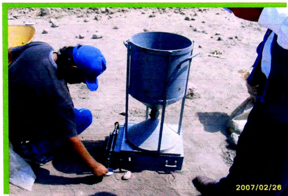
Foto N° 6: Cono para realizar el ensayo de Densidad
