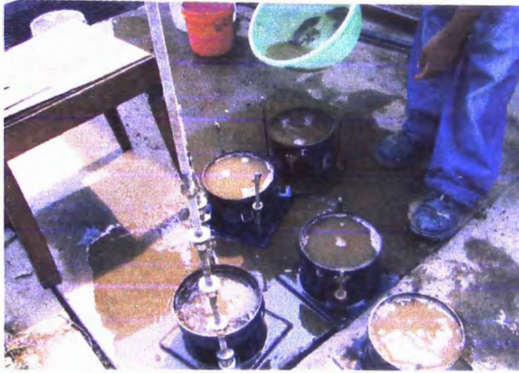
Figura 4.9: Material sometido a compactación en gabinete y saturación al 100% para ensayarse con el DPL
