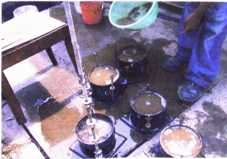
Figura 12: Material sometido a compactación en gabinete y saturación al 100% para ensayarse con el DPL
