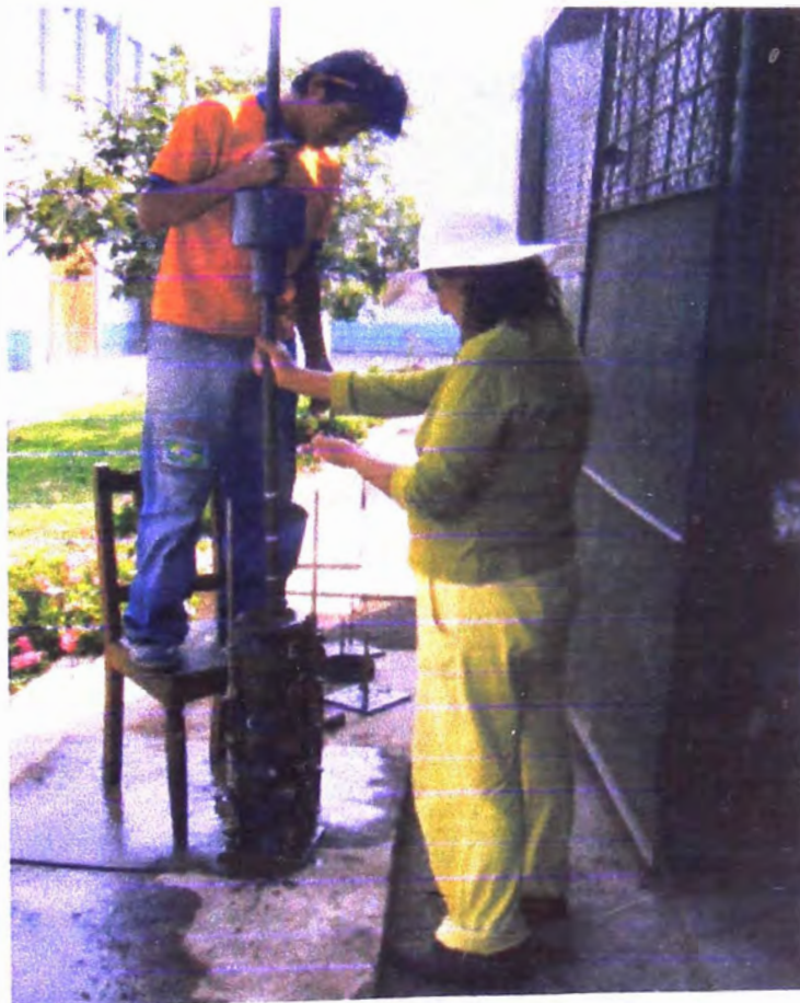
Figura 4.10: Ensayo con el Penetrometro Dinámico Liviano realizado en suelos saturados a diferentes compactaciones.
