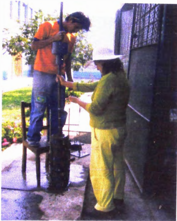
Figura 11: Ensayo con el Penetrometro Dinámico Liviano realizado en suelos saturados a diferentes compactaciones.
