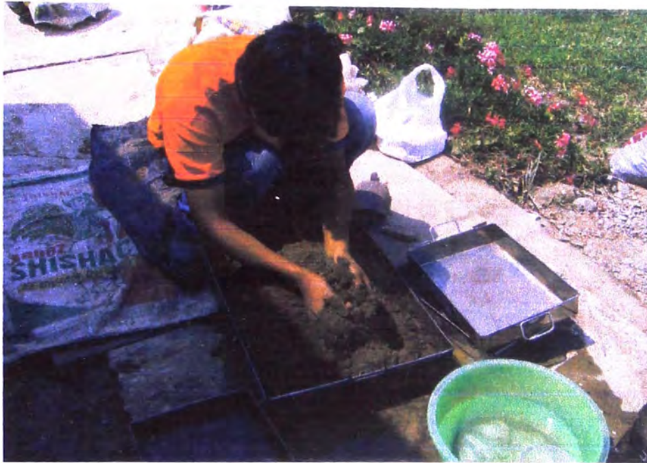
Figura 5: El material que se usara para la degradación en bandeja para ser ensayado en Laboratorio de suelos.
