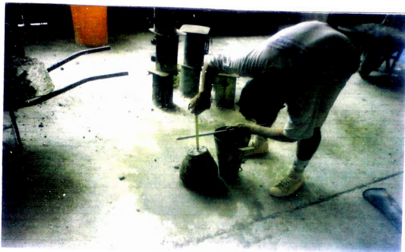
Foto N° 2 : Determinación del Asentamiento – 1 er tanteo
