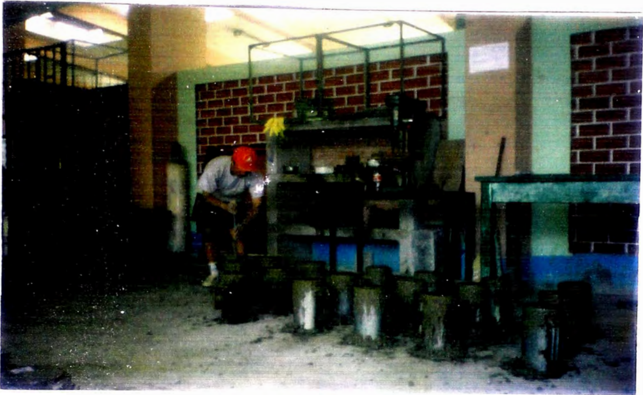
Foto N° 9 : Elaboración de las Probetas de concreto
