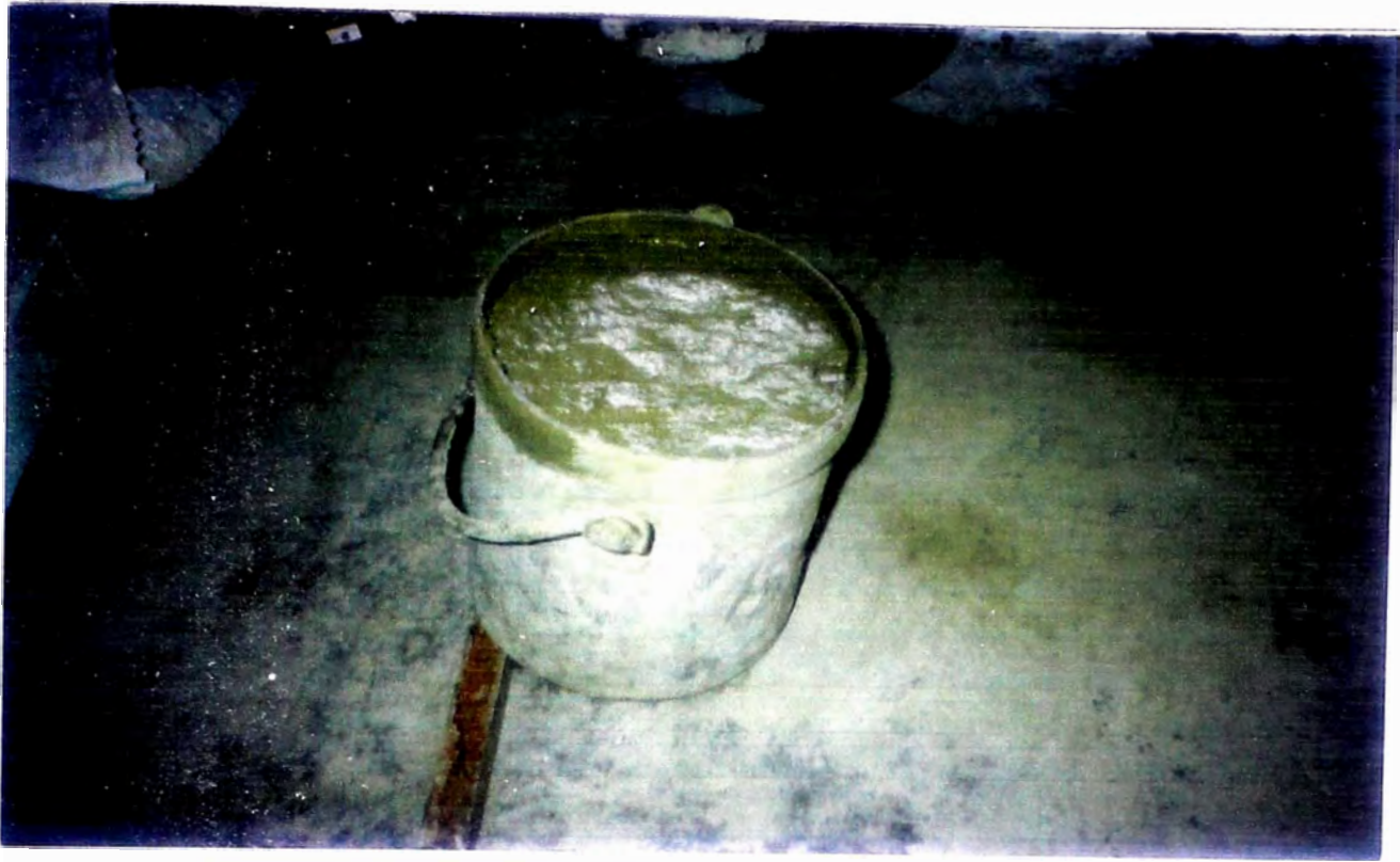
Foto N° 6 : Muestra para el Ensayo de Exudación
