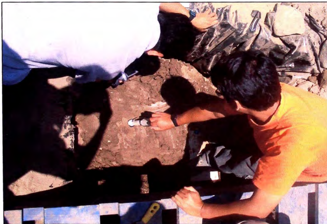
Foto 12 Ensayos con penetrómetro para obtención del CBR
