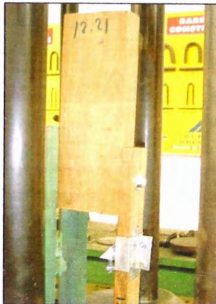
Se realizaron en primera instancia ensayos para determinar la velocidad de ensayo, la cual esta especificada en la Norma ASTM D1761-88 y en relación a la tesis con Madera Quinilla Colorada – *Manilkana Bidentada*, se determinó una velocidad de ensayo que permita la lectura de datos cada 50 kilogramos de carga, para tener suficientes puntos al inicio de la curva esfuerzo-deformación.
