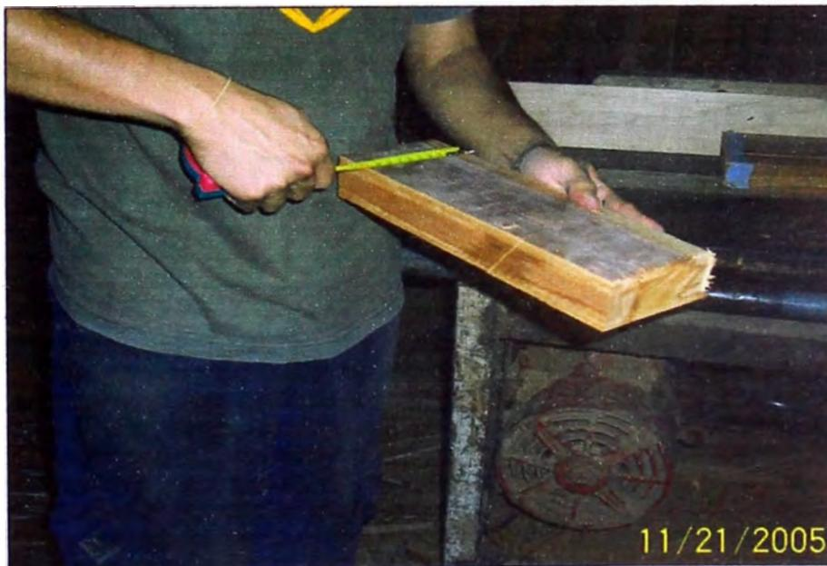
**Fotografía N° 6. Madera cortada para elaboración de probetas.**
