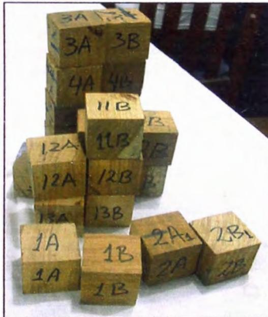
**Fotografía N° 21: Muestras para ensayo de contenido de humedad**
