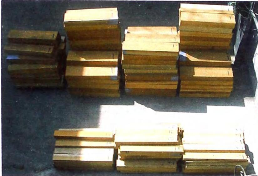
Según la Norma ASTM D1761-88 las características de las probetas a usar deben ser de un material de madera representativo, limpio y con fibras paralelas en una dirección. Las dos piezas prismáticas de madera utilizadas para este ensayo deben ser planas y sin asperezas para poder ser unidas entre ellas. La cantidad de ensayos debe de ser lo suficientemente para permitir un análisis estadístico.
