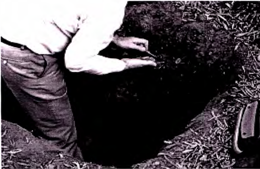
Fig. 2.3 Toma de muestras de una calicata.
