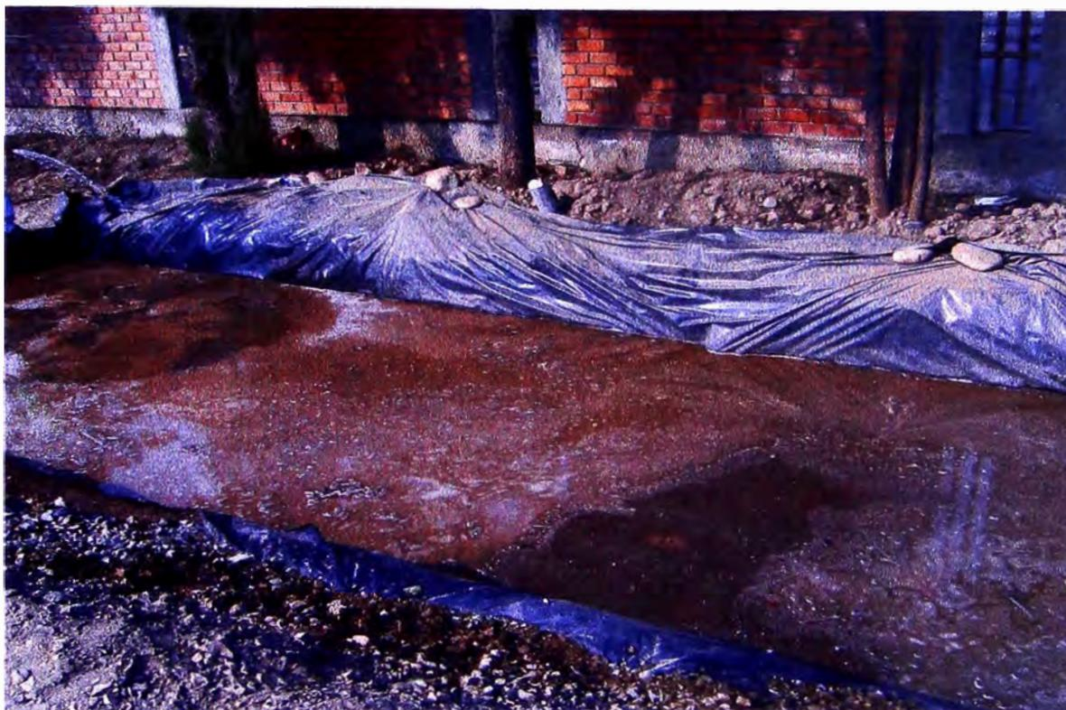
Fotografía N° 03.- Material saturado, así simular la condición más crítica, donde los CBR son menores.
