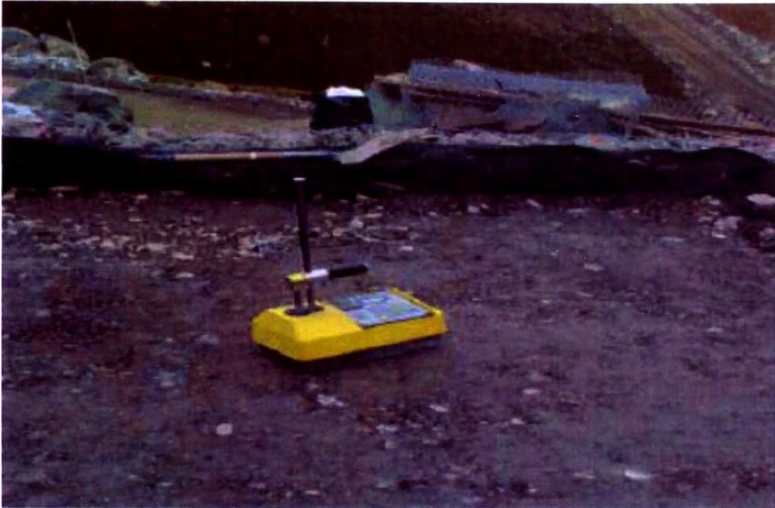
Ilustración 2.17. Prueba de compactación en campo con densímetro nuclear
