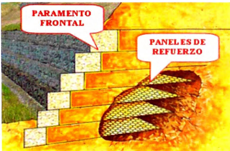
Ilustración 2.1. Corte transversal de muro reforzado con el sistema Terramesh
