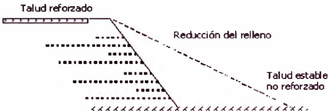
Ilustración 1.8. Incremento de la pendiente de un talud estable no reforzado
