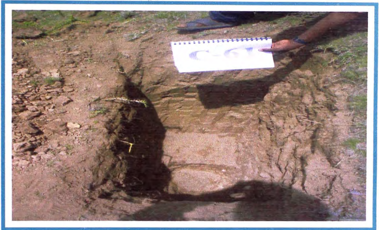
FOTO N° 13: Pozo C-61.- Se observa superficialmente y hasta la profundidad de 0.40m limo arenoso, con presencia de raíces delgadas, color beige, continuando y hasta la profundidad explorada de 1.50m, con limo arenoso, con gravas, color beige.
