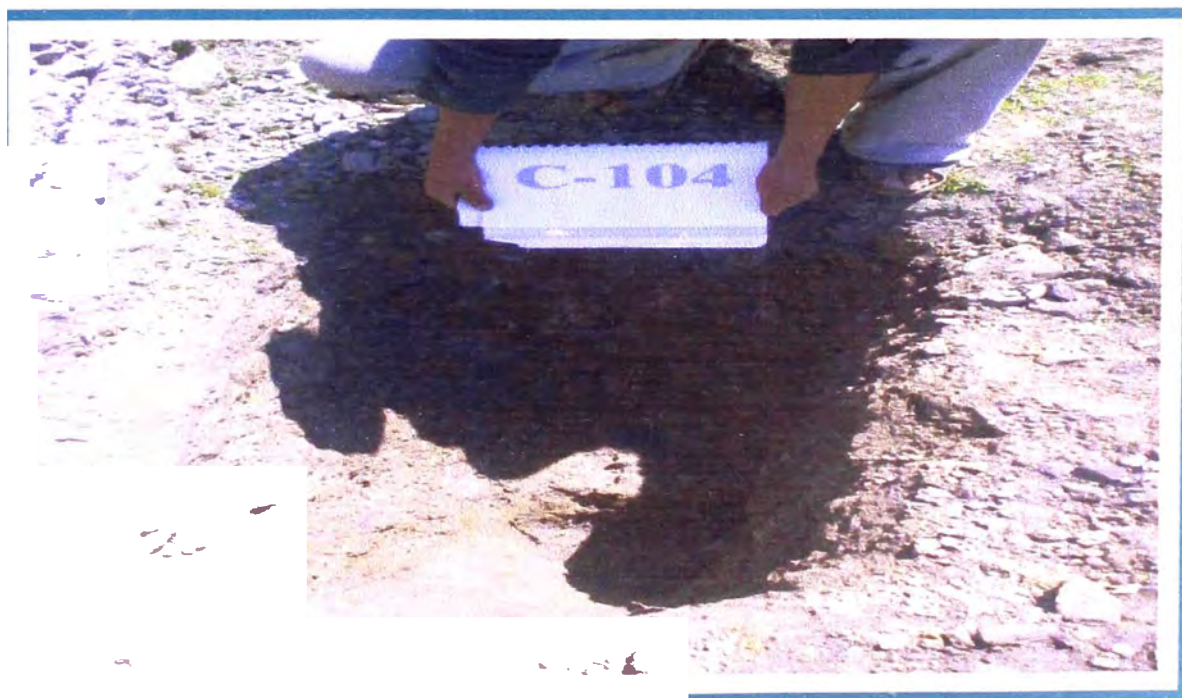
FOTO N° 20: Pozo C-104.- Se observa superficialmente y hasta la profundidad explorada de 1.50m, con limo arenoso, con gravas, color beige.
