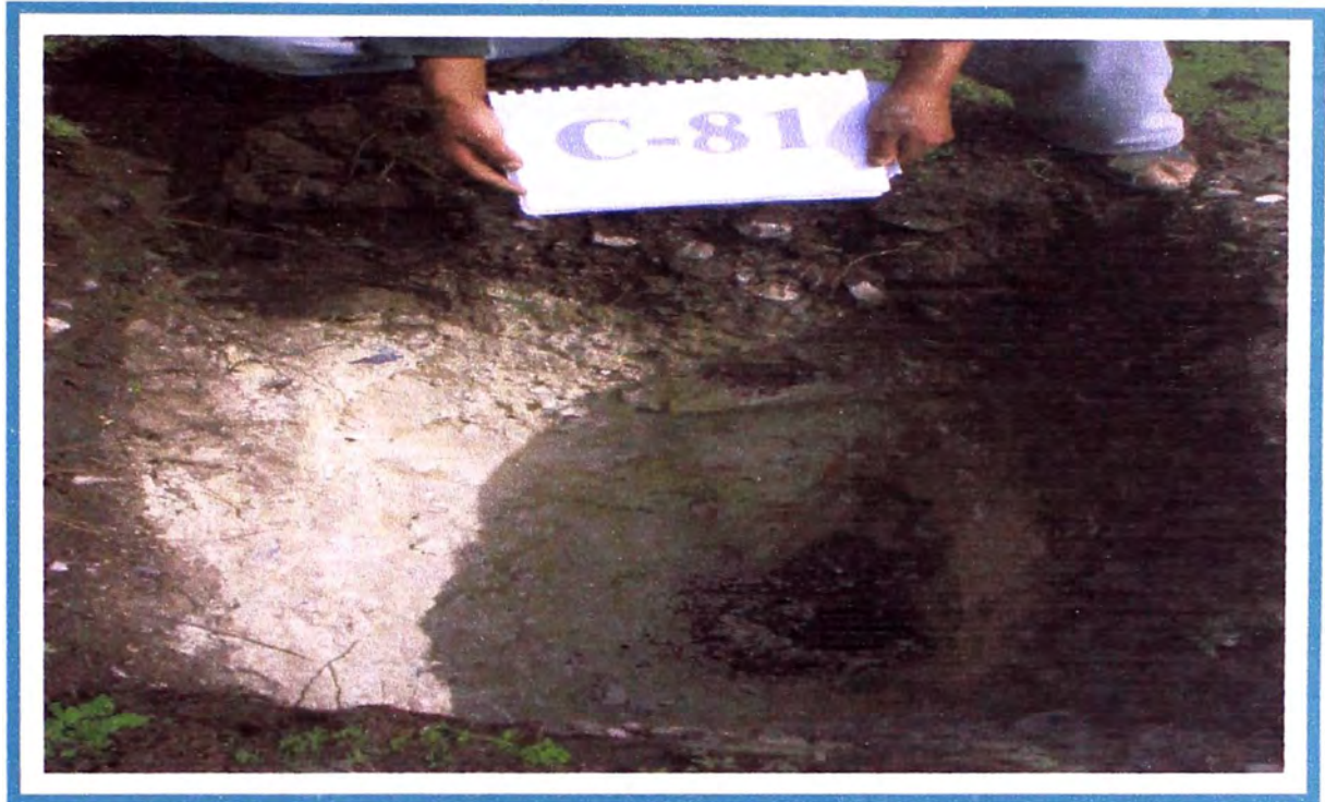
FOTO N° 17: Pozo C-81.- Se observa superficialmente y hasta la profundidad de 0.60m limo arenoso, con presencia de raíces delgadas, color beige oscuro, continuando y hasta la profundidad explorada de 1.50m con gravas con matriz de arena limosa, con presencia de cantos aislados, color blanquecino.
