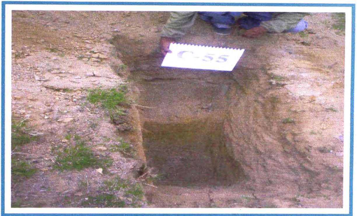
FOTO N° 9: Pozo C-55.: Se observa superficialmente y hasta la profundidad explorada de 1.50m arena, limosa, color beige amarillento
