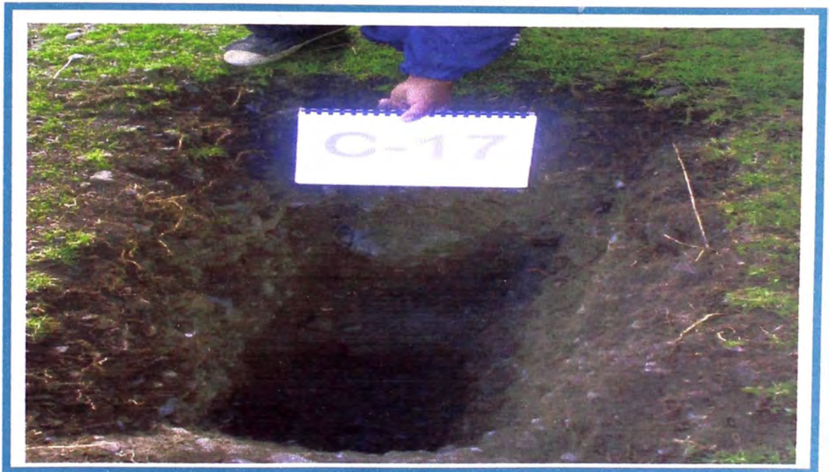
FOTO N° 4: Pozo C-17.- Se observa superficialmente y hasta la profundidad de 0.40m arcilla arenosa con gravas y raíces delgadas, color beige, continuando y hasta la profundidad explorada de 1.50m con grava arenosa, arcillosa, color beige.
