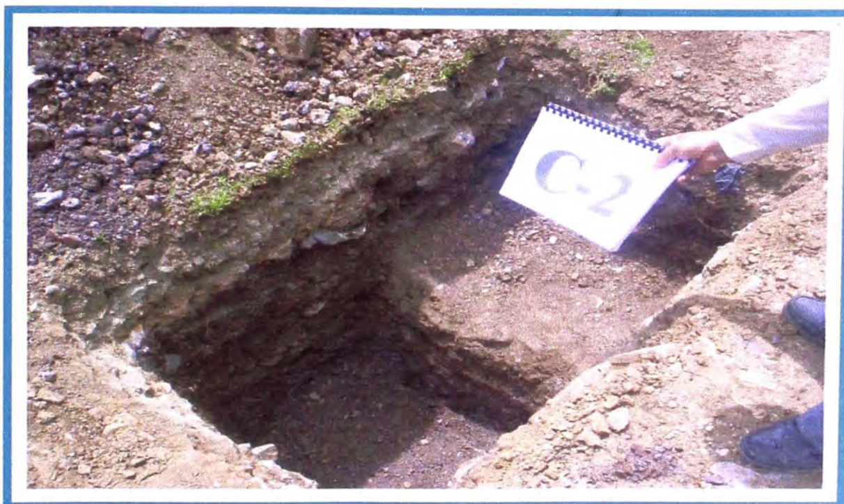
FOTO N° 2: Pozo C-2.- Se observa superficialmente y hasta 0.10m arcilla lastrada, luego grava arcillosa-limosa hasta 0.20m, continuando con arcilla con grava, color blanquecina hasta 0.50m por debajo y hasta la profundidad explorada de 1.50m limo poco arenoso, color blanquecino.
