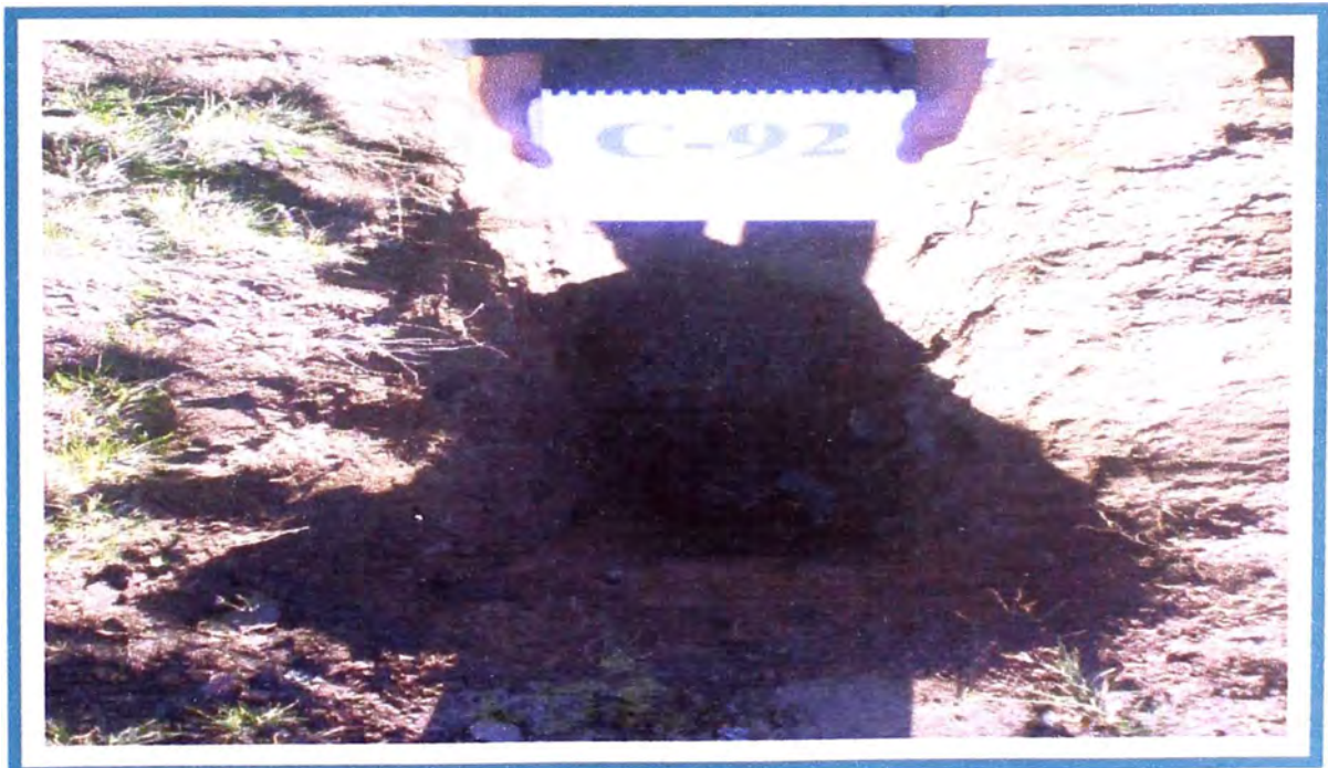
FOTO N° 18: Pozo C-92.- Se observa superficialmente y hasta la profundidad explorada de 1.50m, arena limosa, con gravas y cantos aislados, color beige.
