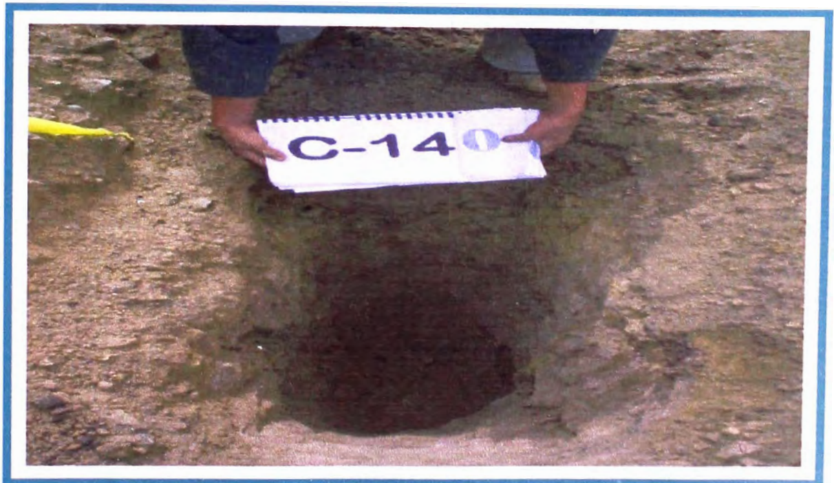
FOTO N° 22: Pozo C-140.- Se observa superficialmente y hasta la profundidad de 0.20m grava lastrada luego y hasta la profundidad de 0.25m limo arcilloso color negruzco continuando y hasta la profundidad de 1.50m roca muy intemperizada convertida en arena y ligeramente limosa con gravas.
