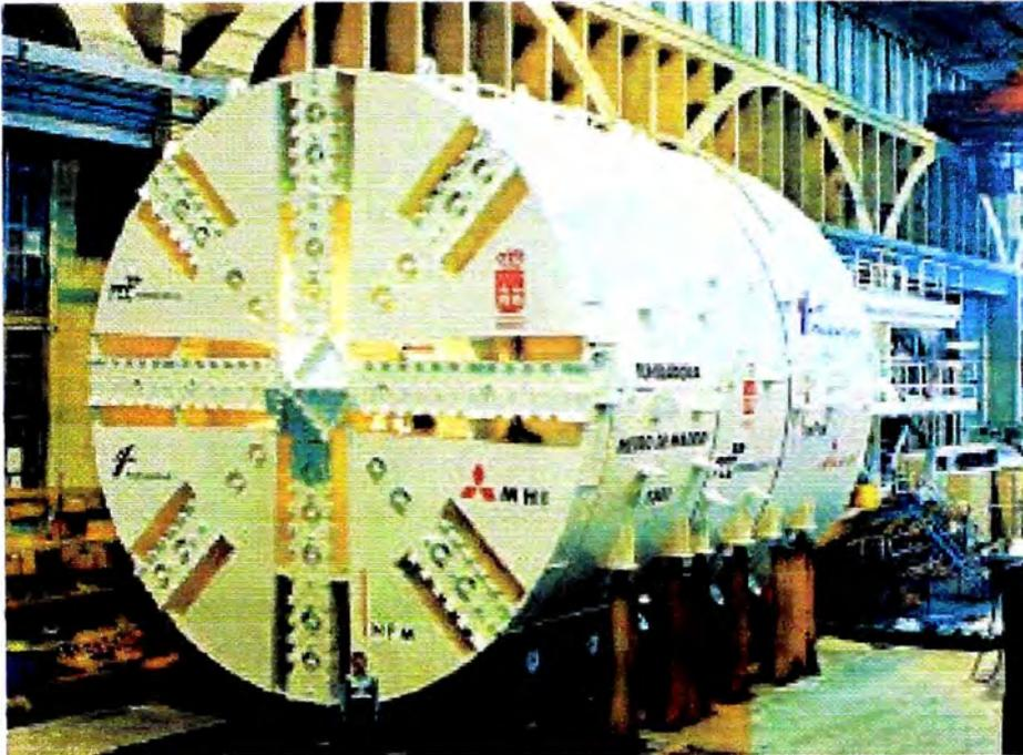
Foto 7.3 Ejemplo Máquina excavadora para el túnel.
