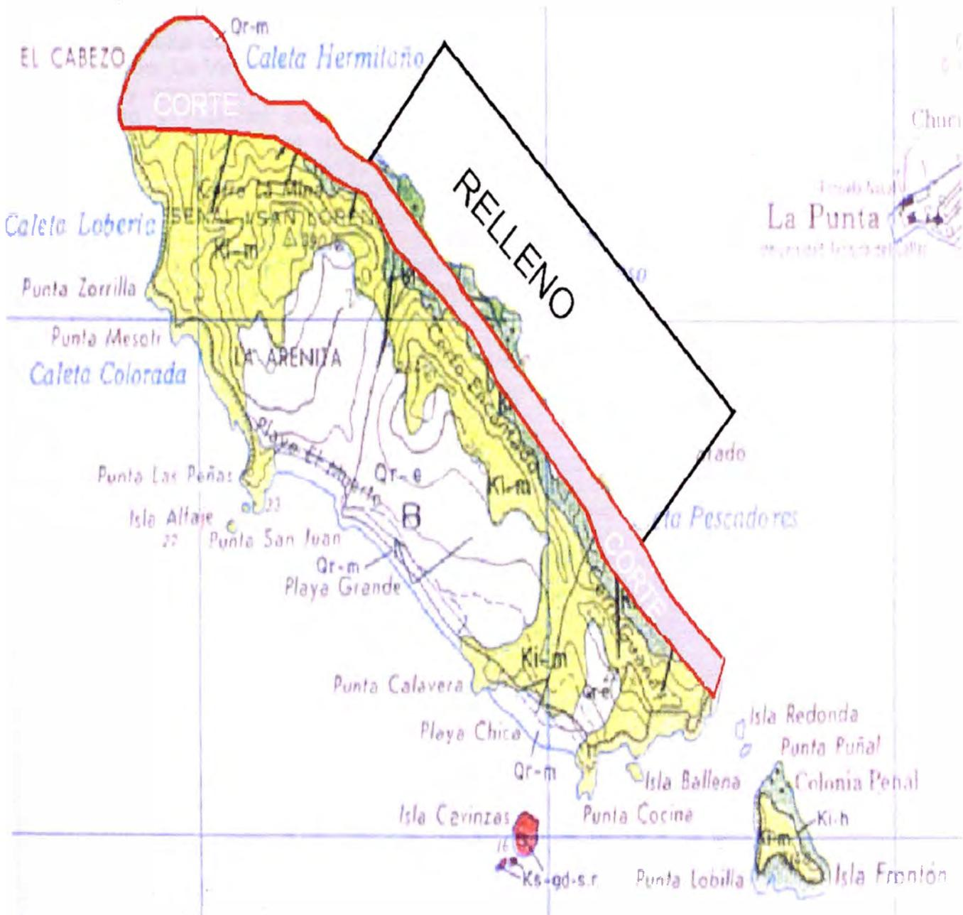
Figura 4.10 Zonas de corte y relleno para el proyecto
