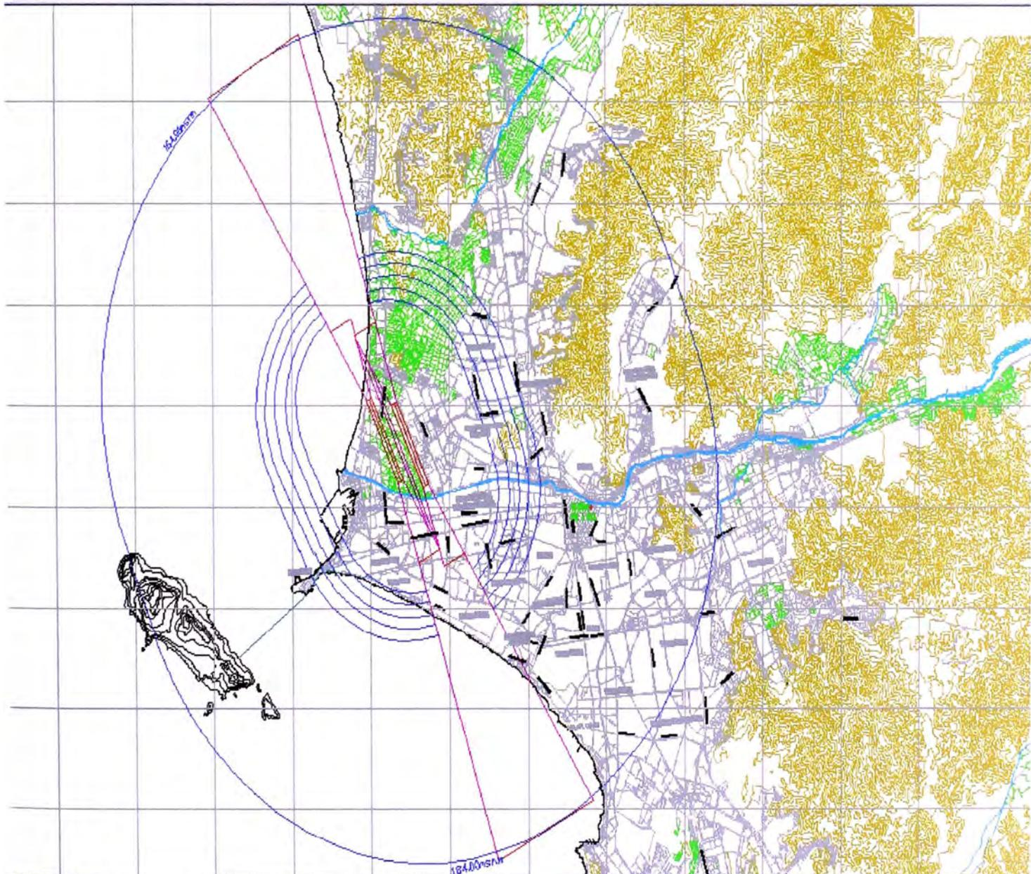
Figura 5.3 Superficie limitadora de obstáculos del sistema de dos pistas comprendidas en el plan maestro del AIJCH, se observa el gran porcentaje de área urbana comprendida dentro de estas superficies.
