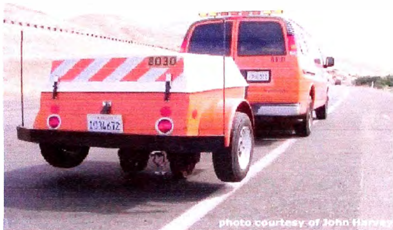
Figura N° 2.02 Equipo Dynaflec Transportado
