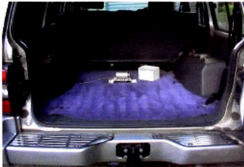
FIGURA 2.2: Equipo Bump Integrator y vehículo instalado
