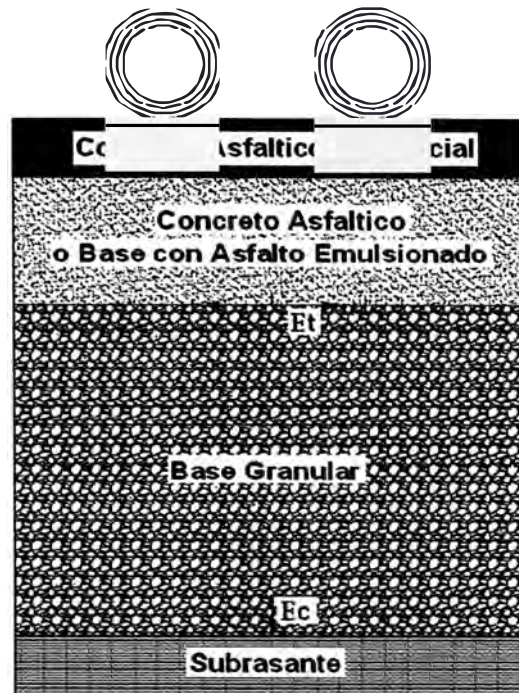
FIGURA Nº 2.02 PAVIMENTO ASFÁLTICO EN TODO SU ESPESOR
