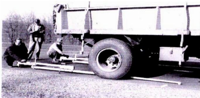
**Figura N° 2.1 Viga Benkelman**
