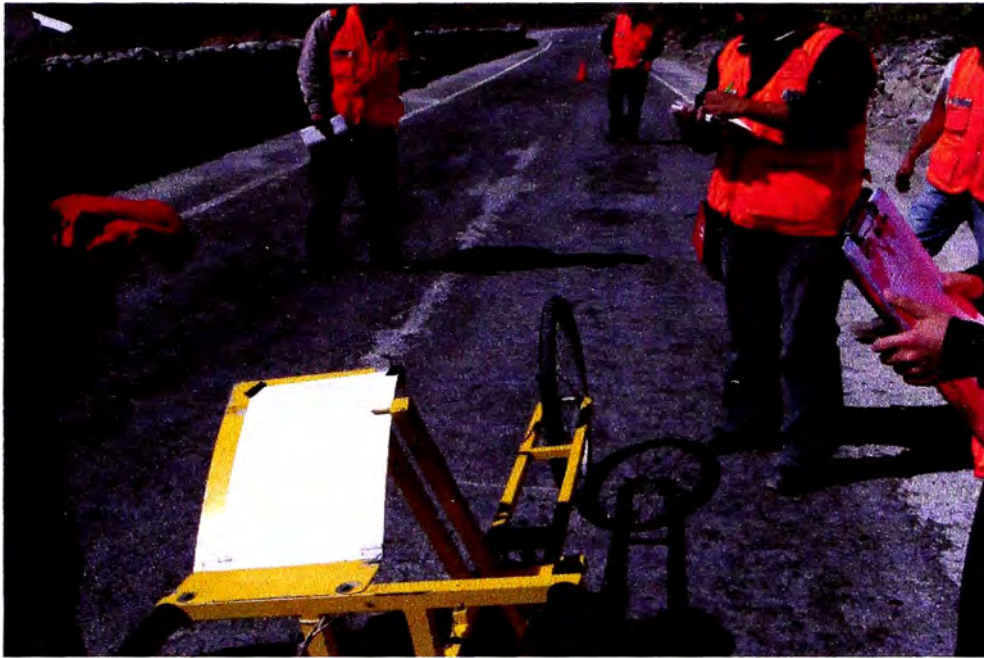
Figura N° 3.02: Vista del inicio del ensayo mediante la colocación de la planilla de toma de datos sobre el Equipo rugosímetro MERLIN.
