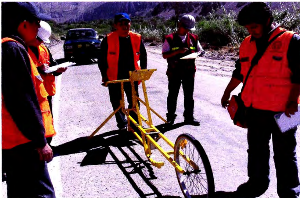
Figura N° 3.03: Vista del proceso de ensayo y toma de datos. Nótese la ubicación posterior de la camioneta como medida de seguridad.
