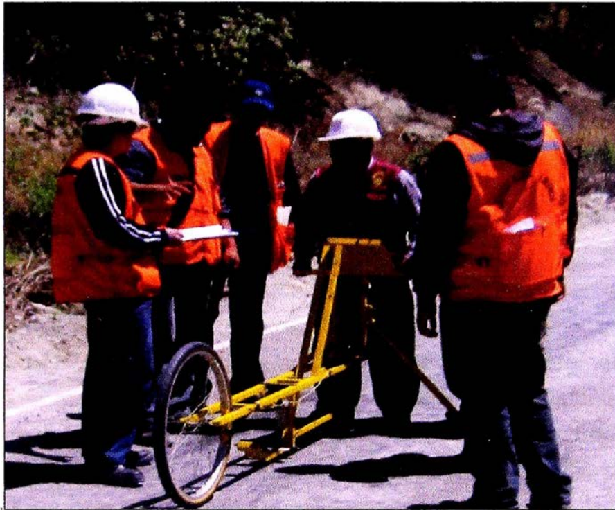
Figura N°2.02 Operación del equipo MERLIN
