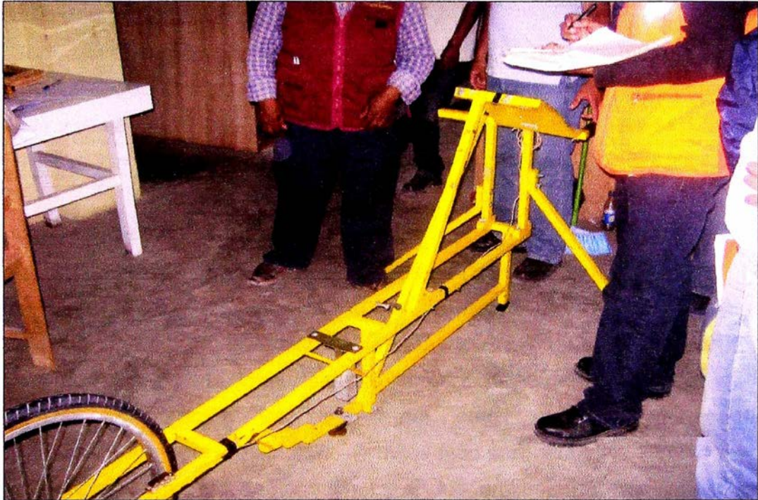
Figura N°3.01 Calibración del equipo MERLIN
