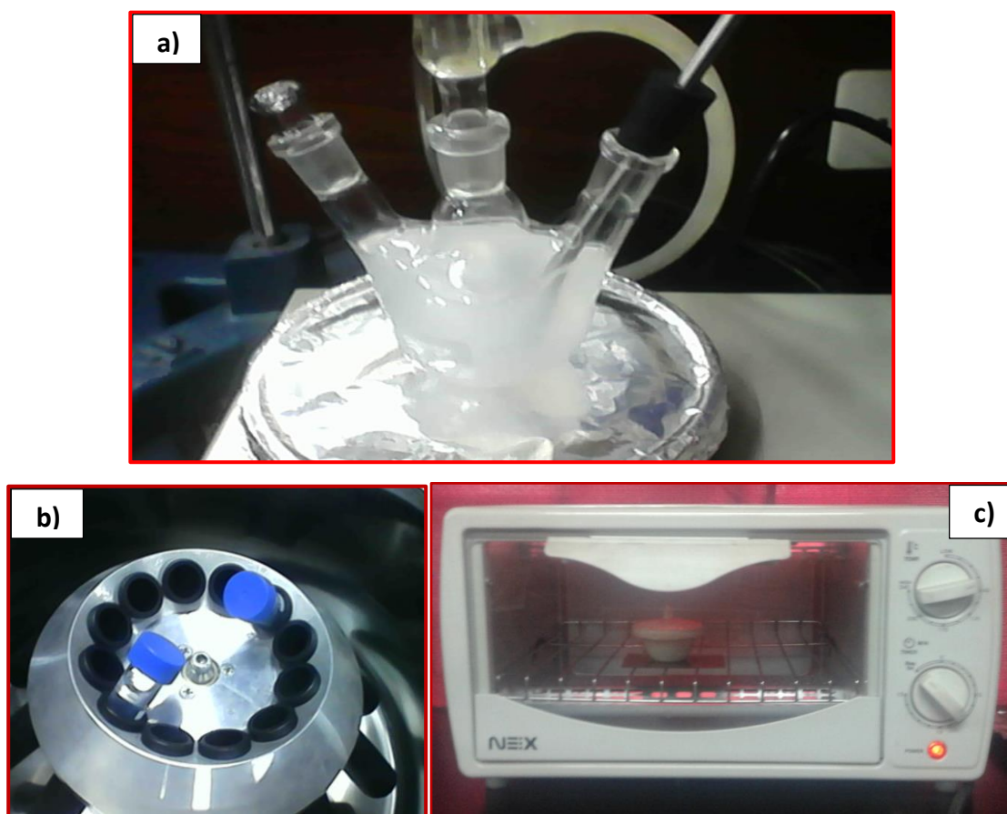
Figura 3.4 Imágenes de los diferentes procedimientos seguidos en la síntesis de nanopartículas de \text{LaF}_3:\text{Er}^{3+}, \text{Yb}^{3+} . (a) Proceso de agitación rápida y calentamiento dentro del vaso de tres entradas. (b) proceso de centrifugado y secado del precipitado previamente obtenido en el paso a). (c) Proceso de secado del nanomaterial obtenido en el paso b).
