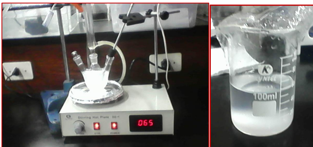
Figura 3.2 IZQUIERDA: Imagen del proceso de síntesis de nano partículas \text{LaF}_3: \text{Er}^{3+}, \text{Yb}^{3+} (2/20) %mol con agitación y calentamiento continuo. DERECHA: Imagen de sedimentación del precipitado formado, el cual contiene las nanopartículas de \text{LaF}_3: \text{Er}^{3+}, \text{Yb}^{3+} , después de calentar y agitar durante 4 horas.
