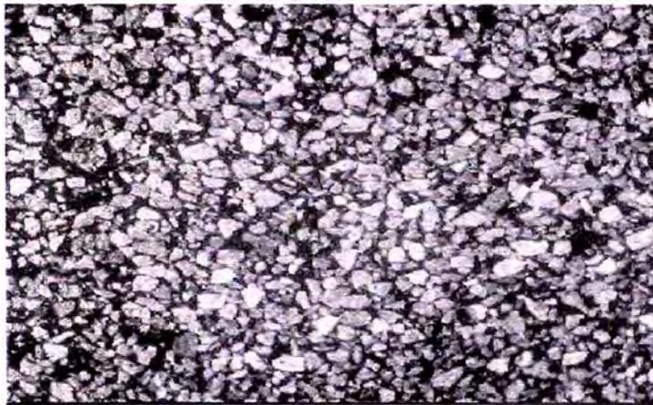
**Fig. X1.34 Agregado Pulido**
