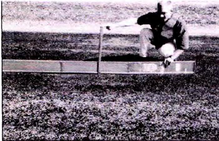
**Fig. X1.16 Depresión – Baja Severidad**
