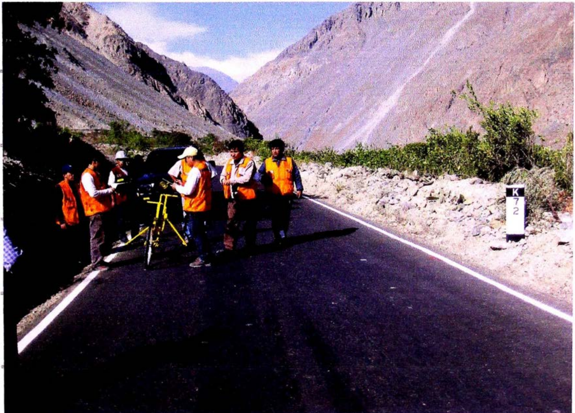
Foto N°06 TOMAS DE DATOS DEL GRUPO 03 ; TRAMO 72+00 AL KM. AL KM 72+400 CARPETA CON SLURRY SEAL
