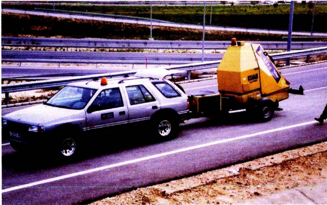
FIGURA N° 2.6 EQUIPO KUAB - FWD
