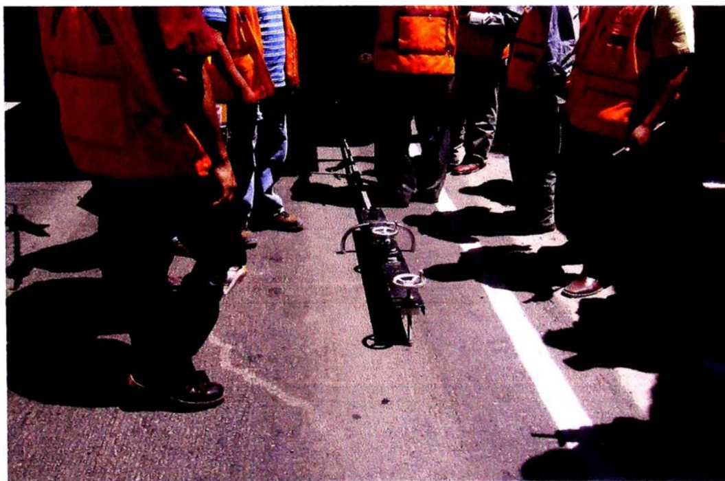
FIGURA Nº 4.1 VIGA BENKELMAN DE BRAZO SIMPLE (RELACIÓN DE BRAZOS 4/1)
