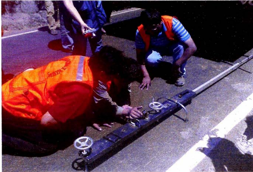
Figura N° 4.2 Lectura de las deflexiones con dial.
