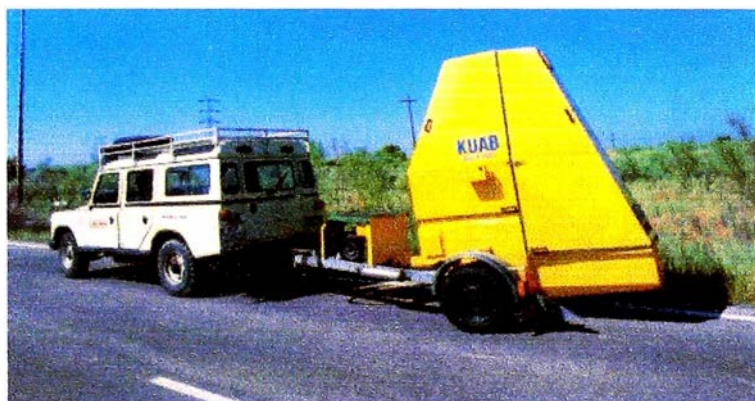
Figura N° 2.6 Equipo KUAB FWD
