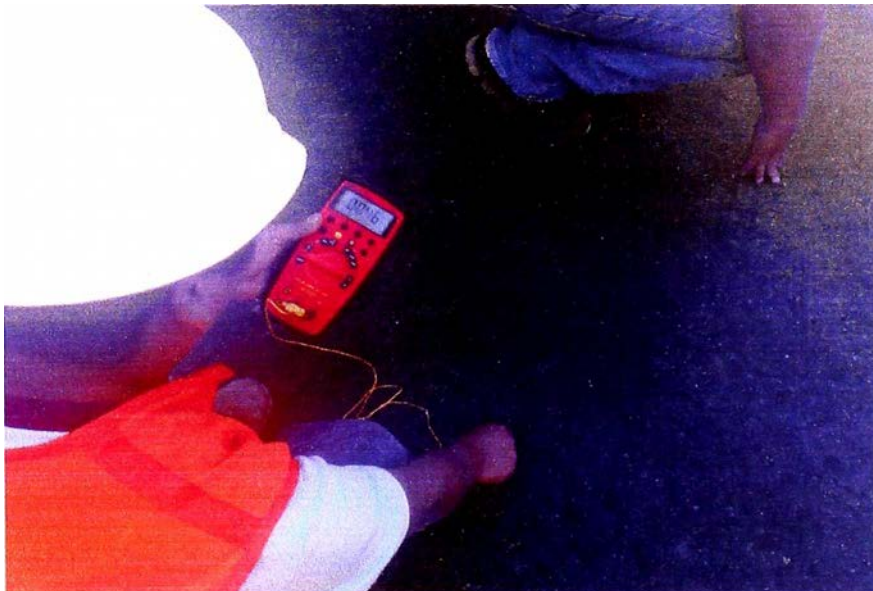
Figura N° 4.3 Toma de temperatura al Pavimento.
