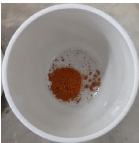
Figura 28: Polvo PET2 color naranja después de tratamiento térmico a 500°C por 1h con rampa de calentamiento de 5°C/min.
