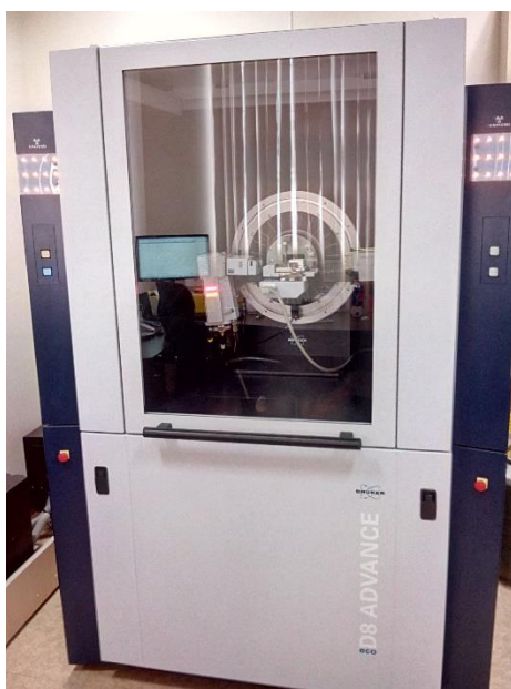
Figura 15: Equipo de difracción de rayos X de fuente de cobalto (Co) de K_{\alpha}=1.78896\text{\AA} .
