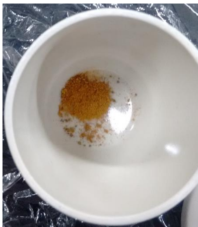
Figura 27: Polvo PTE1 color amarillo-naranja después del tratamiento térmico a 500°C por 1h con rampa de ascenso y descenso de 5°C/min.
