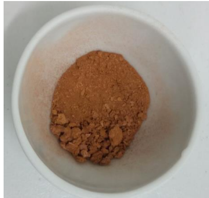
Figura 29: Polvo PET3 color naranja después del tratamiento térmico a 500^{\circ}\text{C} por 1h con rampa de calentamiento de 2^{\circ}\text{C}/\text{min} .
