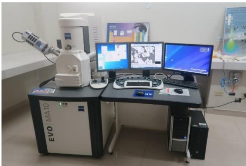
Figura 17: Microscopio electrónico de barrido, Marca Zeiss EVO MA10 SEM, ubicado en el laboratorio de ciencias, UNI.
