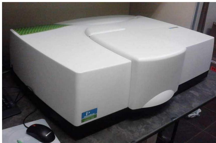
Figura 18: Espectrofotómetro de UV-Vis, marca PerkinElmer, modelo Lambda 1050.
