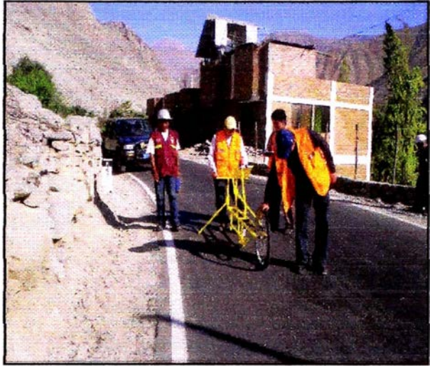
FOTOGRAFÍA N° 3.2 Verificación de las partes instaladas del MERLIN (Fuente: Elaboración propia)
