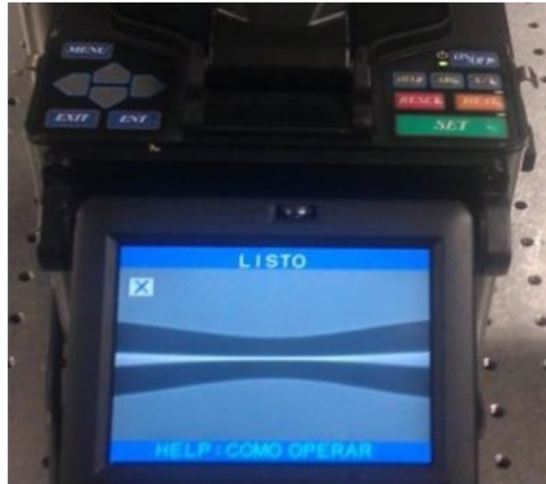
Figura 2.17: Fabricación de un taper una empalmadora Fujikura FSM-40 [7].
