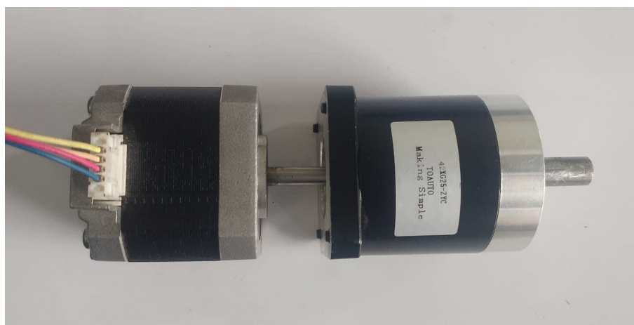
Figura 3.7: Motor a pasos nema 17 y reductor planetario 42XG25-ZYC con relación de transmisión 25:1 (de izquierda a derecha).
