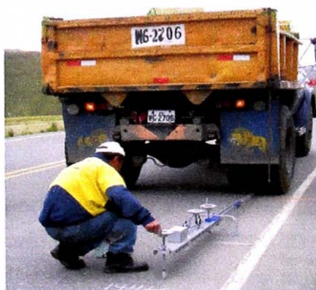
Figura 3.5: Viga Benkelman y camión para toma de deflexiones
