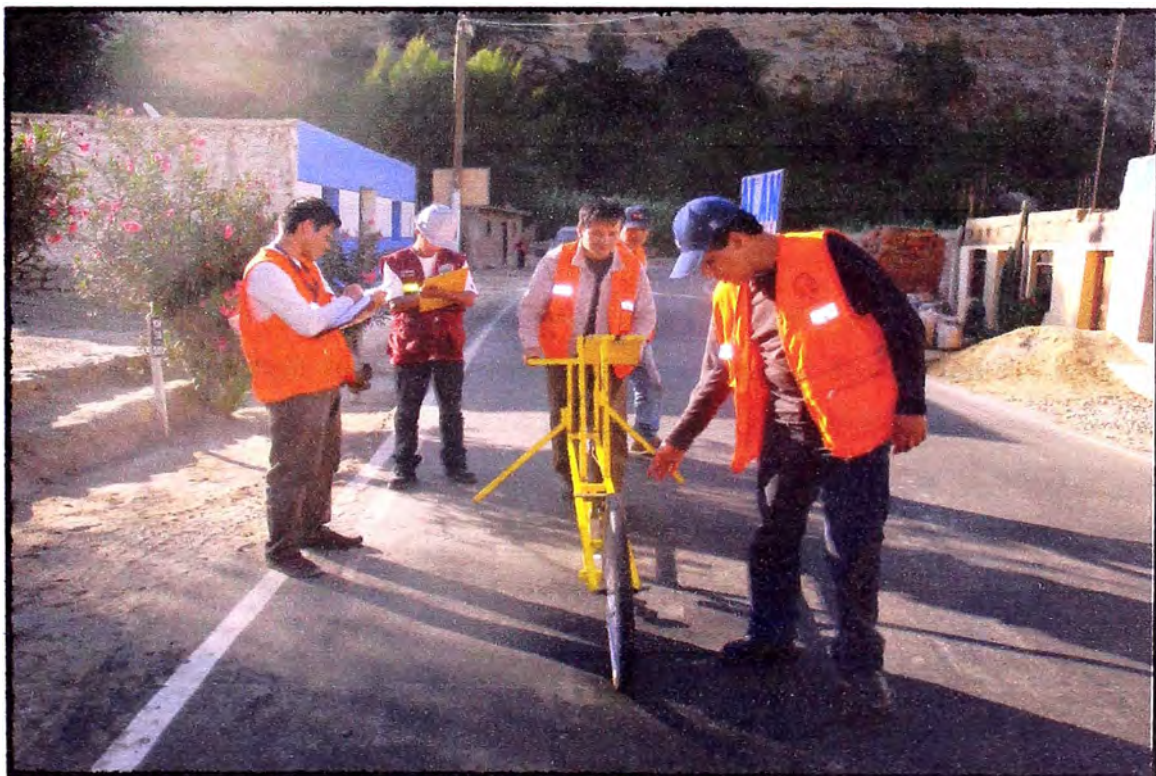
Fotografía N° 2.3: Lectura y recolección de datos con equipo Merlin.
