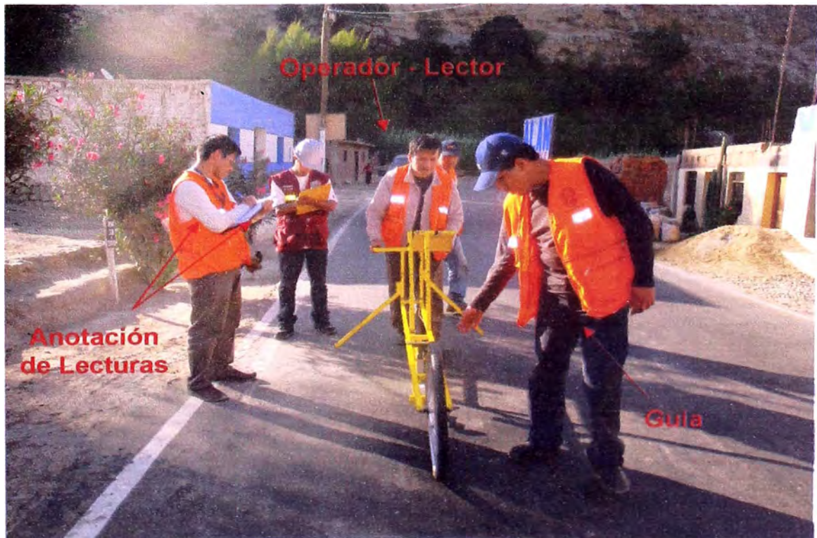
Foto N° 02: Manejo del equipo Merlín y toma de datos
