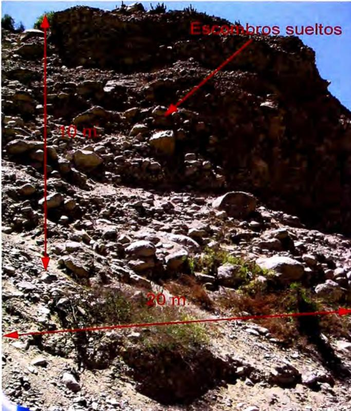
**81+250** Depósito de suelo aluvial, se aprecian fragmentos de roca y bolonerías en gran proporción y de apreciable tamaño con posibilidad de caída a la plataforma. En éste caso, dado el talud, la altura de la misma y la gran área que abarca se recomienda realizar remoción de algunos elementos y la posterior colocación de malla de guiado de piedras.
