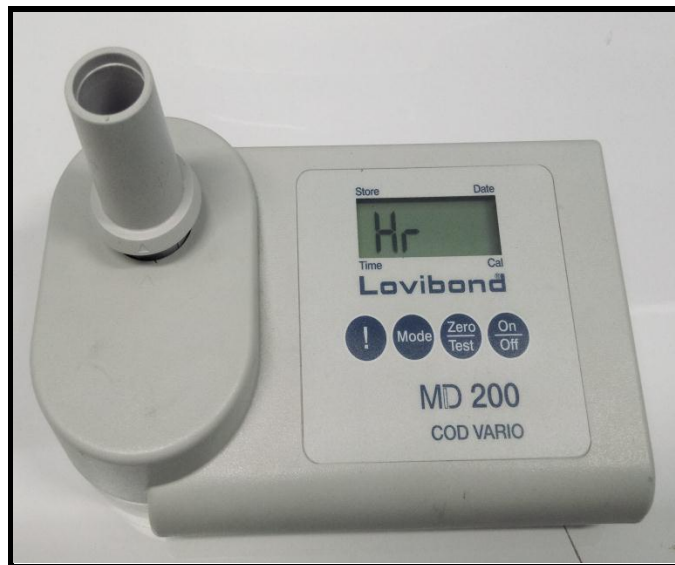
Figura 19. Colorímetro medidor DQO MD200, marca: Lovibond
