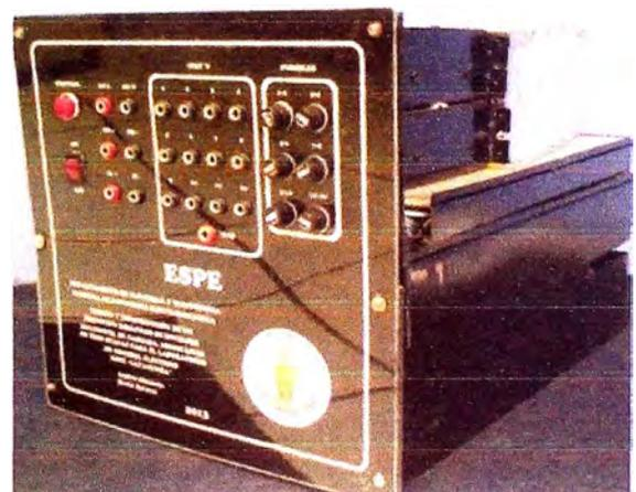
Figura 5. Módulo final del inversor multi-nivel didáctico monofásico en cascada.
