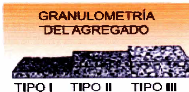
FIGURA N° 2.10 TIPO DE SLURRY SEAL SEGÚN AGREGADOS
