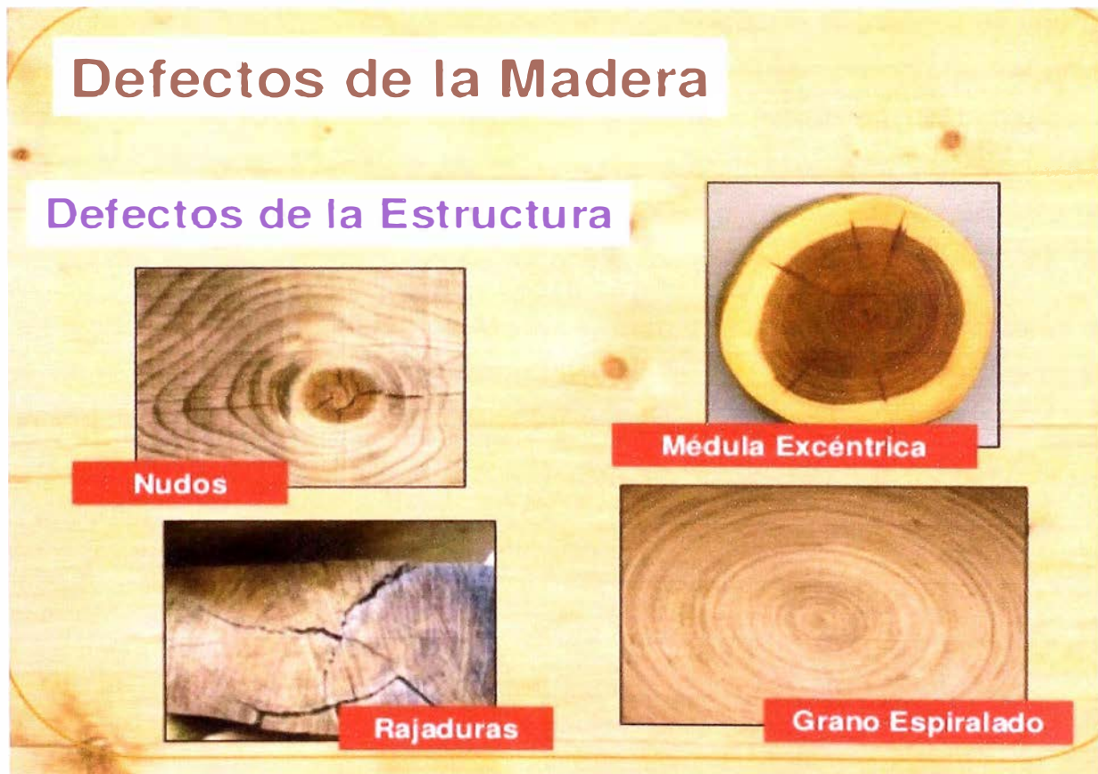
Figura 4: Defectos en la madera. Fuente: https://www.slideshare.net/Yefreide/madera .
