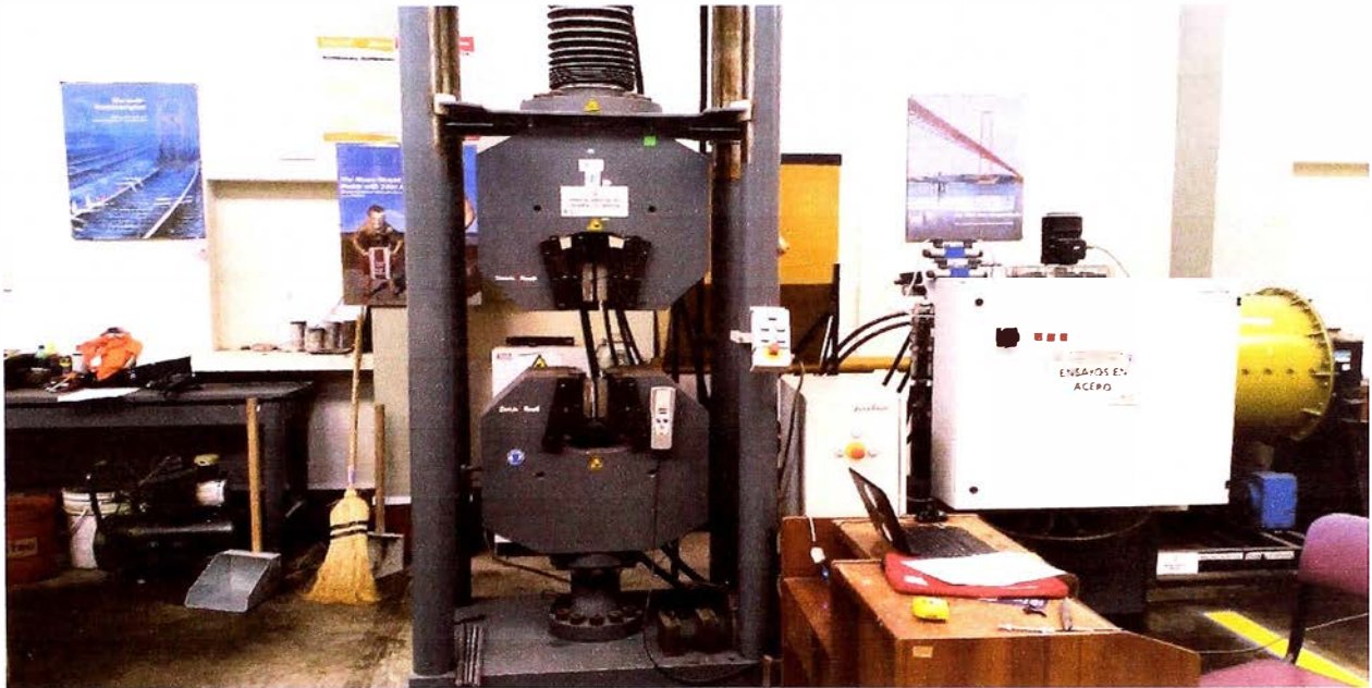
Figura 20: Máquina universal nro. 3, marca Zwick Roell del LEM-UNI con capacidad de 100 ton. Fuente: Propia.
