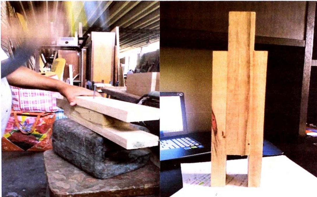
Figura 33: Clavado de las uniones dobles. Fuente: Propia.
