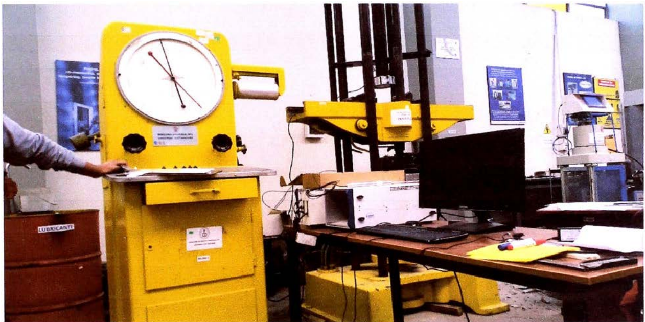
Figura 36: Máquina universal AMSLER con capacidad para 50 ton. Fuente: Propia.
