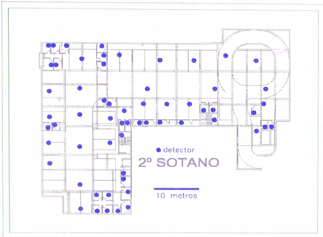
Figura 14. Sistema de detección y alarma en segundo sótano
