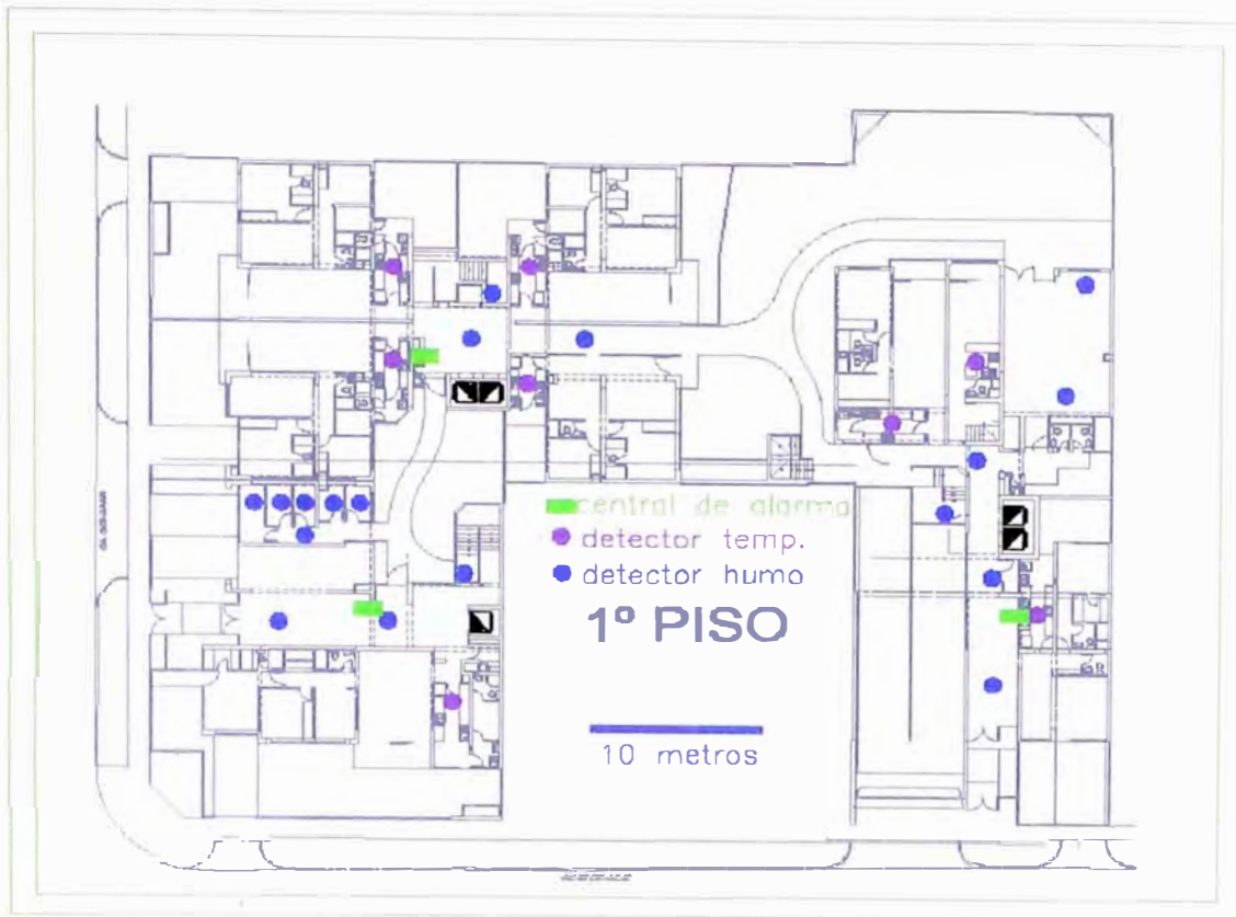
Figura 16. Sistema de detección y alarma en primer piso
