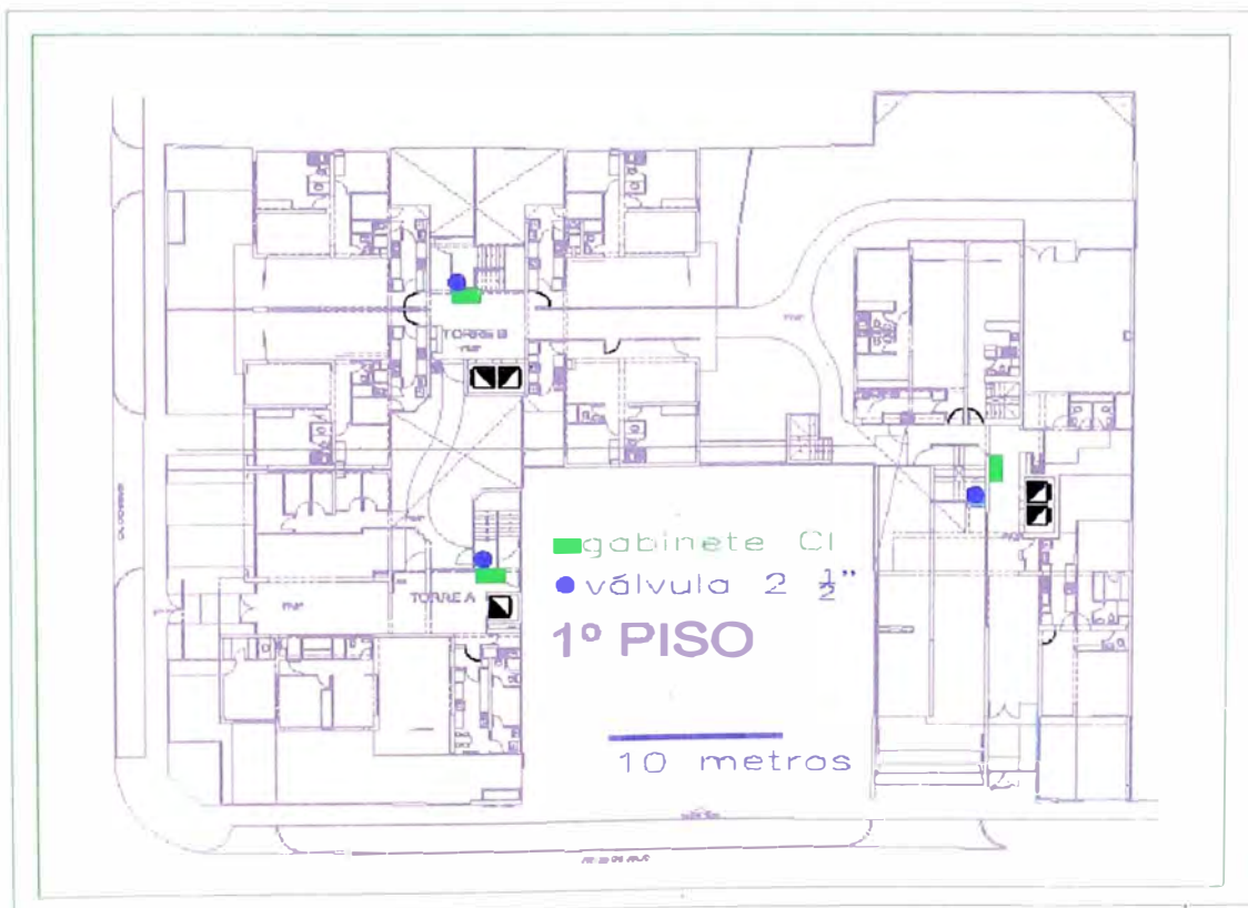
Figura 31. Sistema de extinción en primer piso
