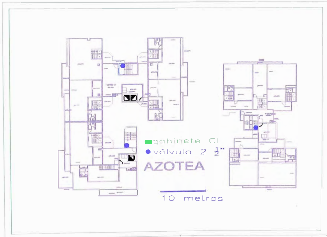
Figura 35. Sistema de extinción en azotea
