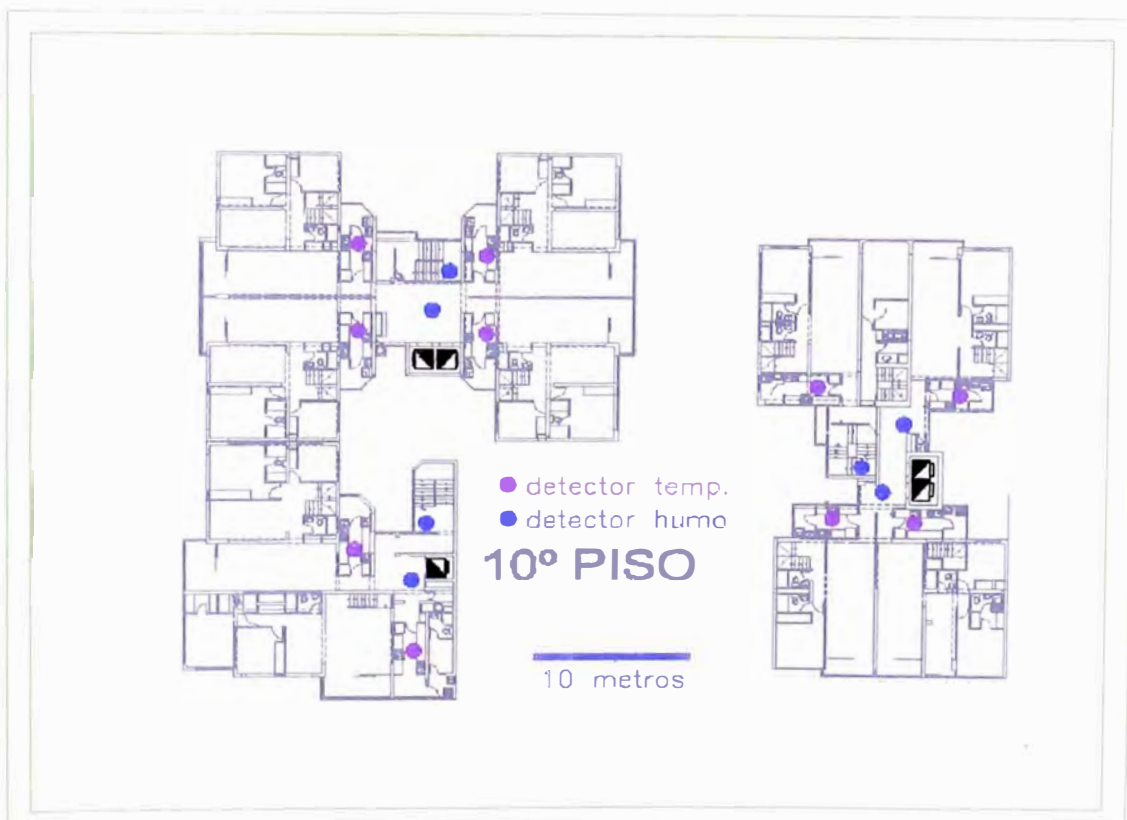
Figura 18. Sistema de detección y alarma pisos 3, 5, 7 y 9
