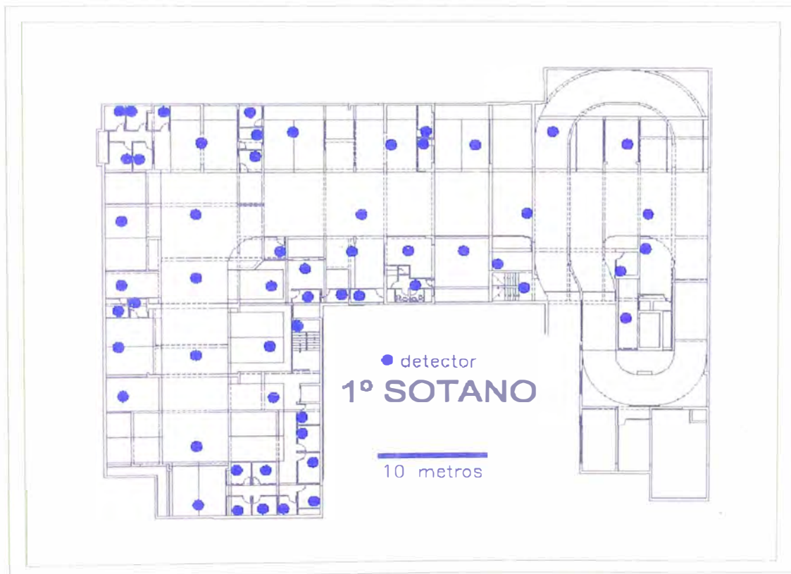
Figura 15. Sistema de detección y alarma en primer sótano
