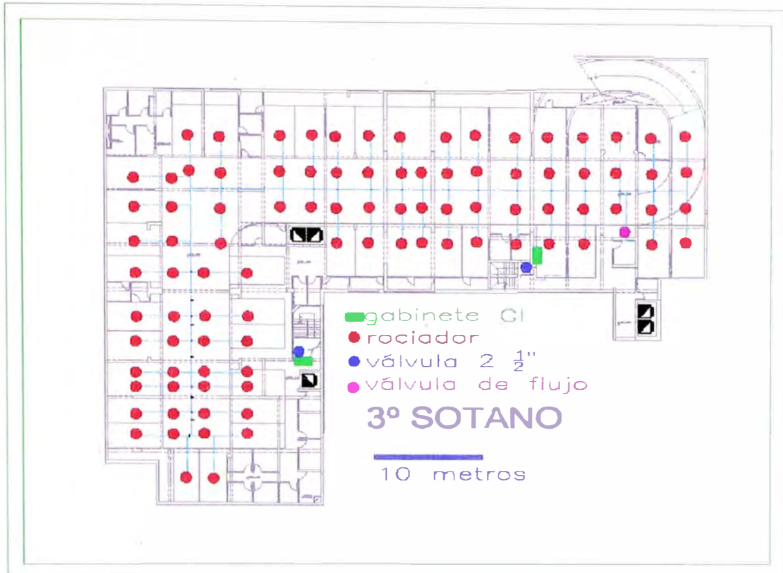
Figura 30. Sistema de extinción en tercer sótano
