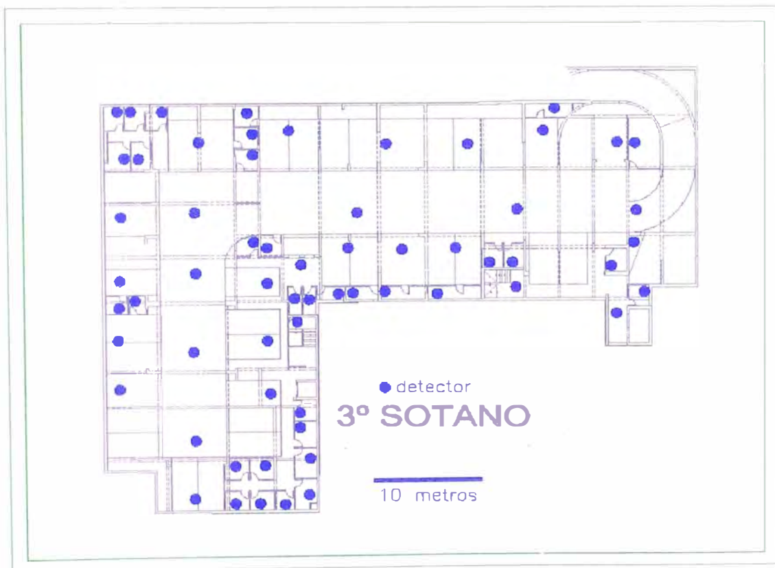
Figura 13. Sistema de detección y alarma en tercer sótano
