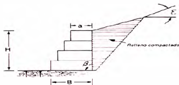
Figura 7 Esquema de gavión como estructura de soporte
