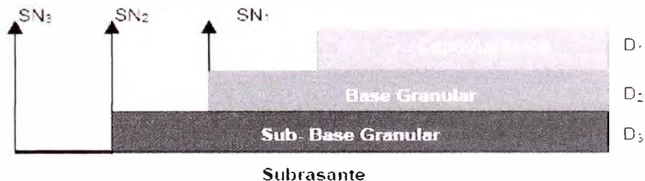
Con la ecuación anterior se obtiene el Número Estructural SN para diferentes grupos de espesores de capas de pavimento que combinados proporcionan la capacidad de carga requerida capaz de soportar el tránsito previsto durante el Período de Diseño. Así, se obtienen los siguientes espesores de Carpeta Asfáltica D<sub>1</sub>, Base Granular D<sub>2</sub> y Sub-base D<sub>3</sub>, respectivamente:
