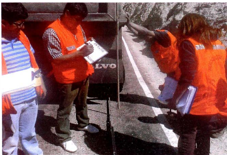
Figura 4.2 Vista de la pos posición de la viga en campo
