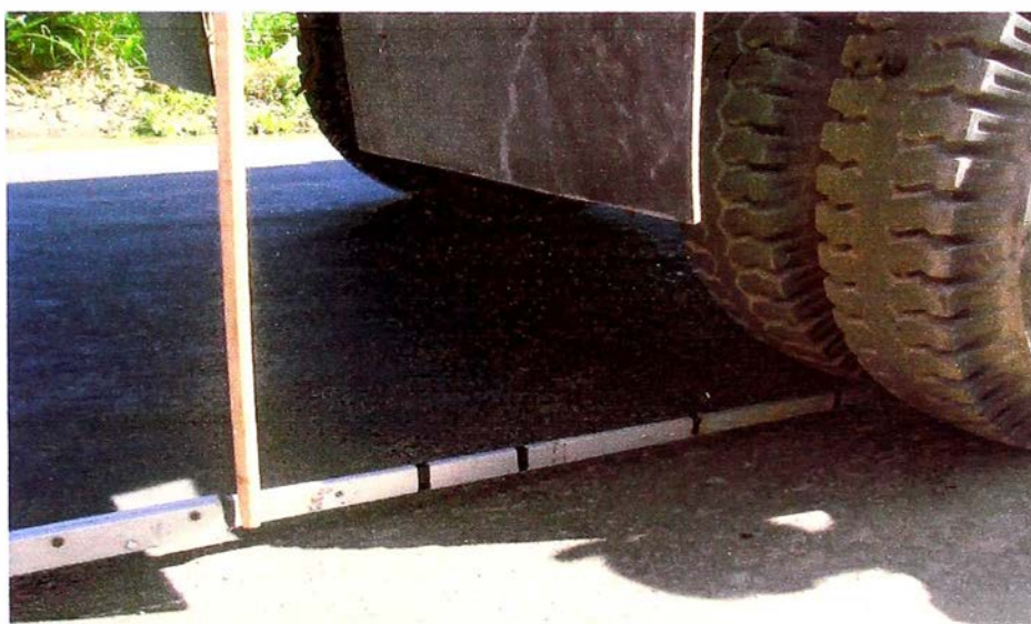
Figura 4.6 Vista de la Viga Benkelman en posición correcta
