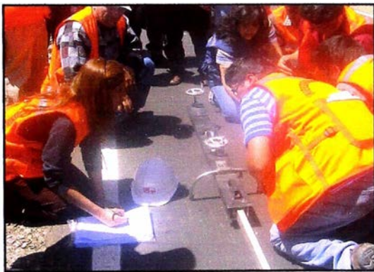
Figura 6.3 Medición de deformaciones
