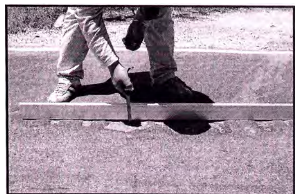
Figura 05: Se observa una falla tipo Hinchamiento de severidad Alta. Figura 06: Se observan varias fallas consecutivas tipo Huevo de severidad Baja. (km 69+000 – km. 70+000)
