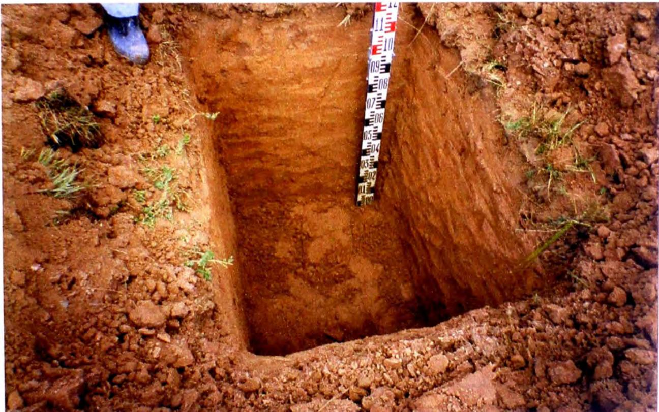
FOTOGRAFIA N°5. Perforación del suelo (Calicata), efectuada en la progresiva 0+060 de la futura Calle de acceso, observando la composición característica del terreno natural, arcilla con un bajo contenido de arena limosa.
